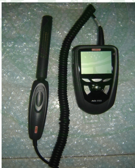
ภาพที่ 8 อุปกรณ์วัดความเข้มข้นก๊าซคาร์บอนไดออกไซด์แบบอัตโนมัติ KIMO รุ่น AQ 200 Air quality
