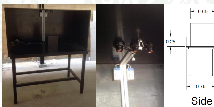
ภาพที่ 15 โต๊ะทดลองและการติดตั้งขั้วหลอดไฟ
