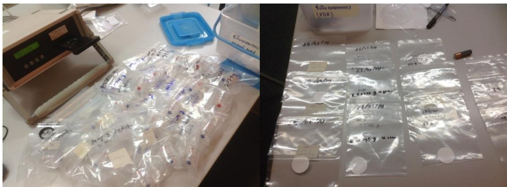
ภาพที่ 45 กระดาษกรอง (Filter Quartz) และเครื่องมือ Soot Scan
