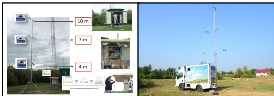
ภาพที่ 17 เครื่องมือตรวจวัดความเร็วลมและทิศทางลมในพื้นที่ใกล้และไกลทะเล
