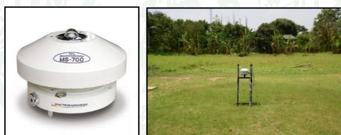
ภาพที่ 18 ชุดตรวจวัดรังสีและเครื่องวัดสเปกตรัมแสง (Spectroradiometer) ยี่ห้อ EKO รุ่น MS-700
