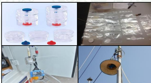
ภาพที่ 20 กระดาษกรอง Quartz fiber และหัวคัตขนาดของฝุ่นไม่เกิน 10 ไมครอน
