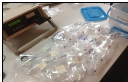
ภาพที่ 19 เครื่องตรวจวัดองค์ประกอบคาร์บอนแบบบอกค่าผ่านช่วงคลื่น (Method an Optical: Aethalometer® SootScan™ Model OT21 Transmissometer)
