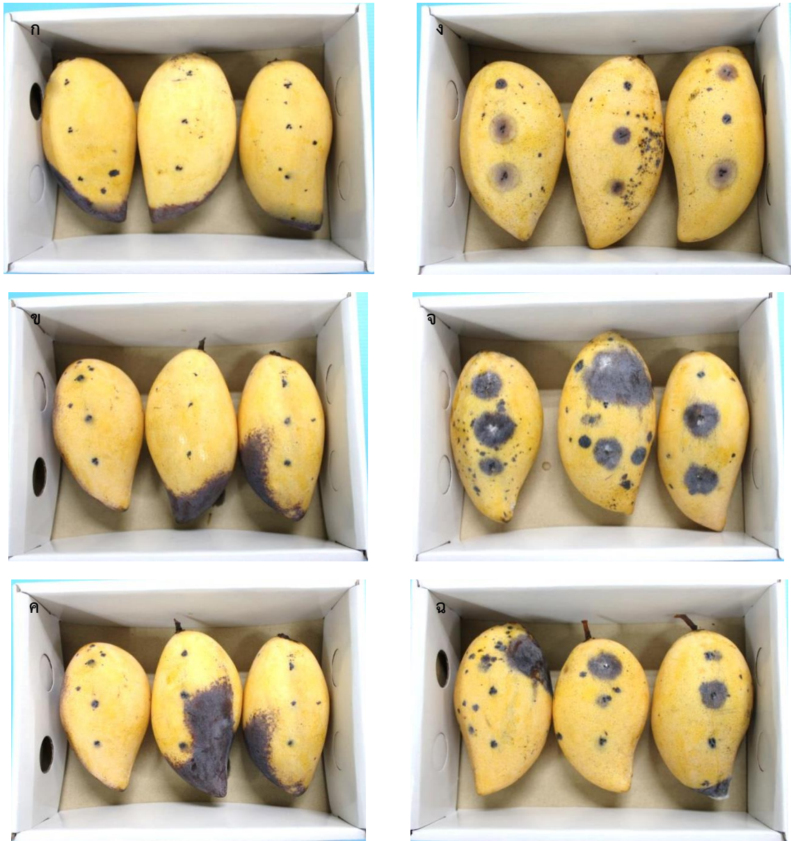
ภาพที่ 34 ประสิทธิภาพของแผ่นควบคุมการเสื่อมเสียของผลไม้ที่มีน้ำมันสูตรผสมระหว่างน้ำมันเมล็ดขาวและยูคาลิปตัส และน้ำมันอบเชยในการต้านการเจริญของเชื้อรา A. niger (ก), C. gloeosporioides (ข) และ L. theobromae (ค) เมื่อศึกษาการประยุกต์ใช้แผ่นป้องกันเชื้อราในการต้านการเจริญของเชื้อราในกล่องกระดาษบรรจุมะม่วงเปรียบเทียบกับเชื้อชุดควบคุม A. niger (ง) , C. gloeosporioides (จ) และ L. theobromae (ฉ) หลังการทดสอบเป็นเวลา 5 วัน
