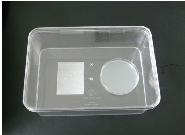
ภาพที่ 18 การทดสอบประสิทธิภาพในการต้านเชื้อราของสูตรผสมระหว่างน้ำมันเสม็ดขาวและยูคาลิปตัสและน้ำมันอบเชยด้วยวิธี modified micro atmosphere system
