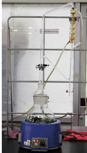
ภาพที่ 8 การกลั่นน้ำมันหอมระเหย ด้วยวิธีการกลั่นด้วยน้ำ
