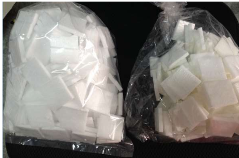
รูปที่ 6 สีของพลาสติกที่เปลี่ยนไปหลังจากการฉายด้วยรังสี UV-B เป็นเวลา 200 ชั่วโมง
