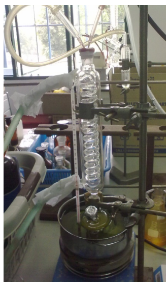
ภาพที่ 6 ชุดอุปกรณ์สำหรับการรีฟลักซ์ภายใต้บรรยากาศของแก๊สไนโตรเจน
