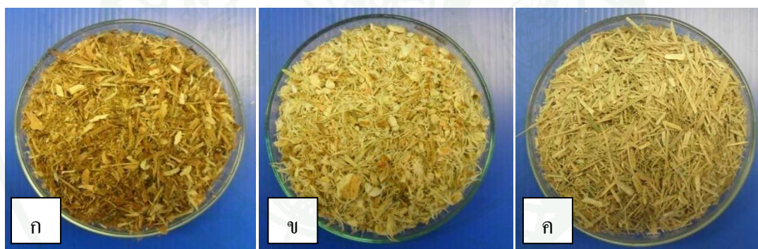
ภาพที่ 22 (ก) จุกสับประรด (ข) เปลือกทุเรียน และ (ค) ยอดและใบอ้อย ที่ผ่านการลดขนาดด้วยเครื่องสับไม้ (wood chopper) ที่มีขนาดตะแกรง 2 มิลลิเมตร
