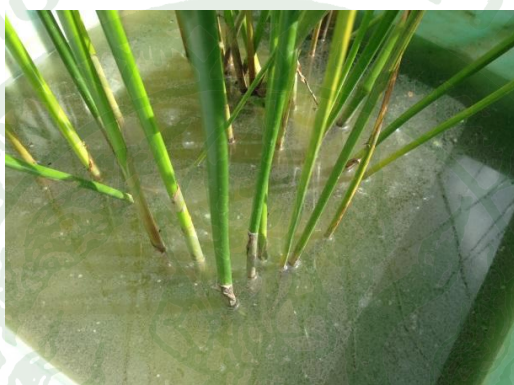
ภาพที่ 38 การทดลองในหน่วยย่อยขนาดเล็กด้วยกกกลมแข่งน้ำเสีย
