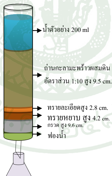
ภาพที่ 24 คอลัมน์บรรจุชั้นวัสดุปลูกสำหรับการทดลองแบบไหลต่อเนื่อง
