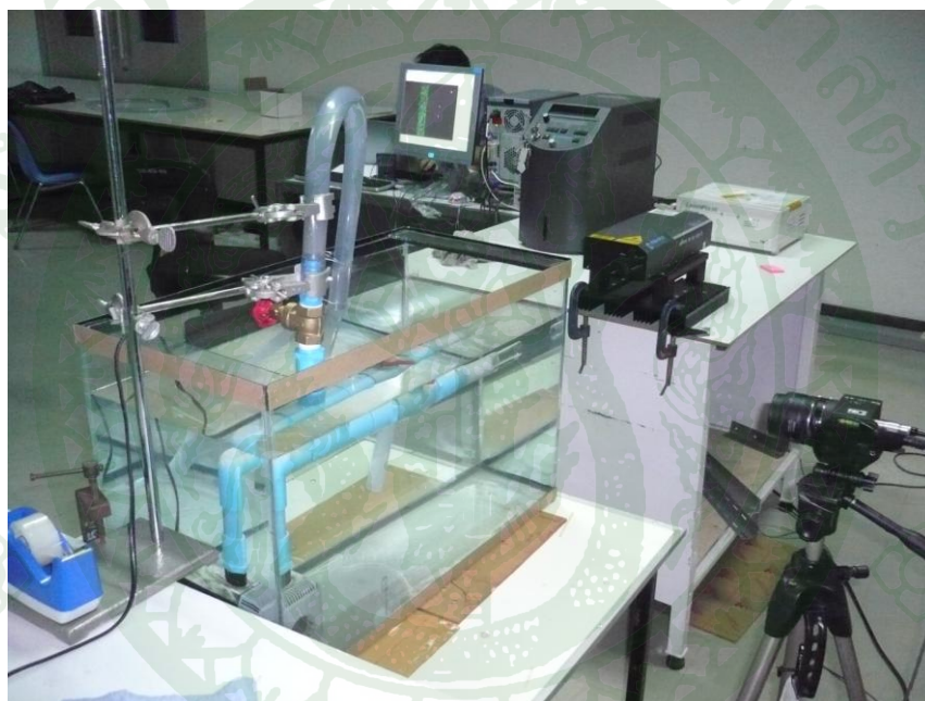
ภาพที่ 27 ชุดทดลองการไหลและเครื่องมือวิเคราะห์ความเร็วอนุภาค
