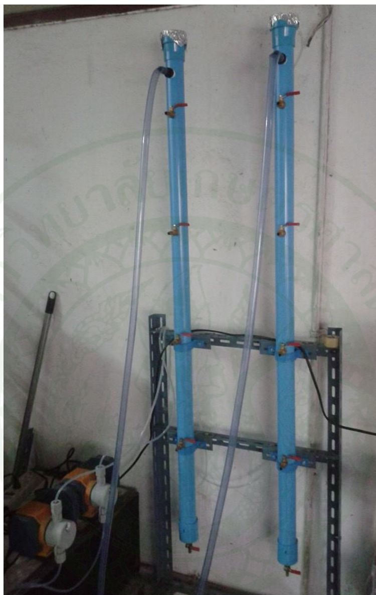
ภาพที่ 18 หอดูดซับทดลองที่ใช้ในการดูดซับแบบต่อเนื่อง
