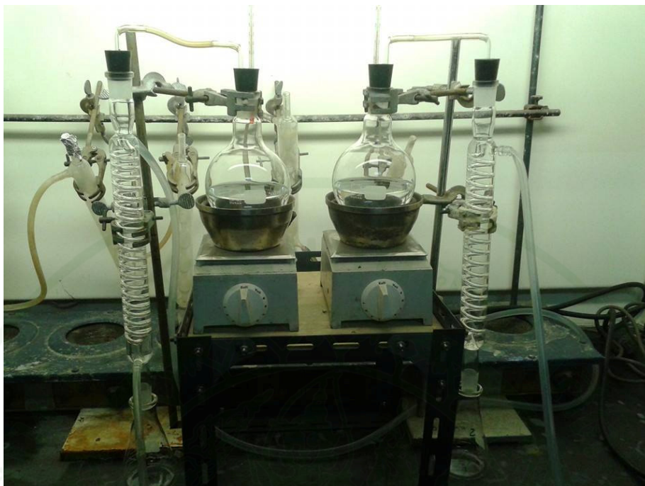
ภาพที่ 11 ชุดกลั่นสำหรับหาความเข้มข้นของกรดไขมันระเหยง่าย (VFA) ในน้ำเสียสังเคราะห์
