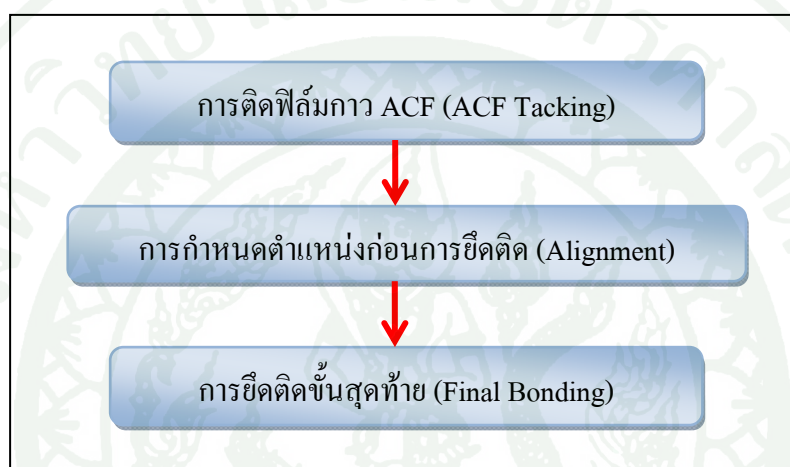
ภาพที่ 1 กระบวนการยึดติด ACF
