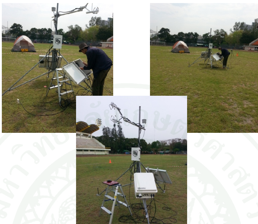
ภาพที่ 13 การติดตั้งเครื่องมือ IRGASON และ NR – 01 ในพื้นที่ซีเมนต์ 0% ต่อพื้นที่สีเขียว 100% บริเวณสนามฟุตบอล(สนามอินทรีย์จันทร์สถิตย์)มหาวิทยาลัยเกษตรศาสตร์ วิทยาเขตบางเขน (C0% G100% )
