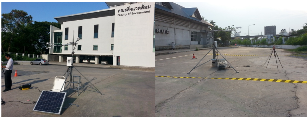
ภาพที่ 9 การติดตั้งเครื่องมือ IRGASON และ NR - 01 ในพื้นที่ซีเมนต์ 100% ต่อพื้นที่สีเขียว 0% บริเวณลานจอดรถ หน้าคณะสิ่งแวดล้อม มหาวิทยาลัยเกษตรศาสตร์ วิทยาเขตบางเขน (C100% G0%)
