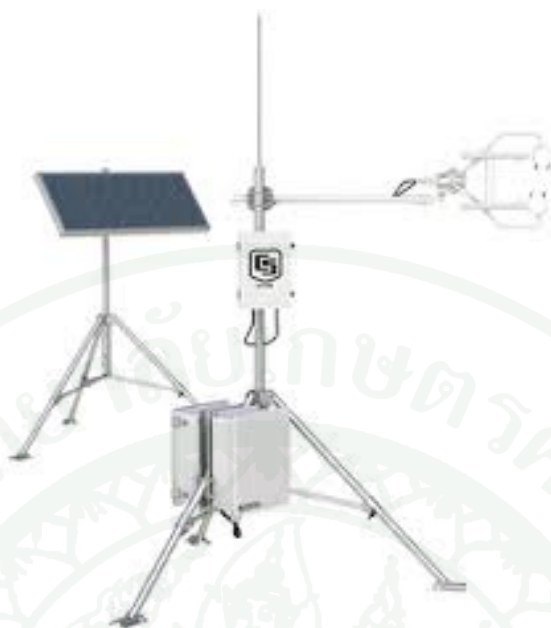
ภาพที่ 3 เครื่องมือUltrasonic Anemometer (IRGASON 3D Sonic Anemometer), เครื่องมือควบคุม (Controller; EC-100) และอุปกรณ์บันทึกข้อมูล (Data Logger; CR-3000)
