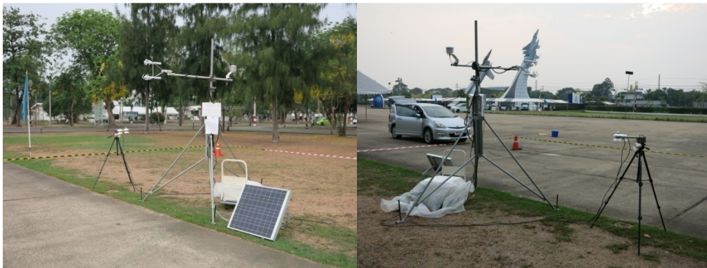
ภาพที่ 11 การติดตั้งเครื่องมือ IRGASON และ NR – 01 ในพื้นที่ซีเมนต์ 50% ต่อพื้นที่สีเขียว 50% บริเวณลานสวนสนาม โรงเรียนนายเรืออากาศ ดอนเมือง (C50% G50% )
