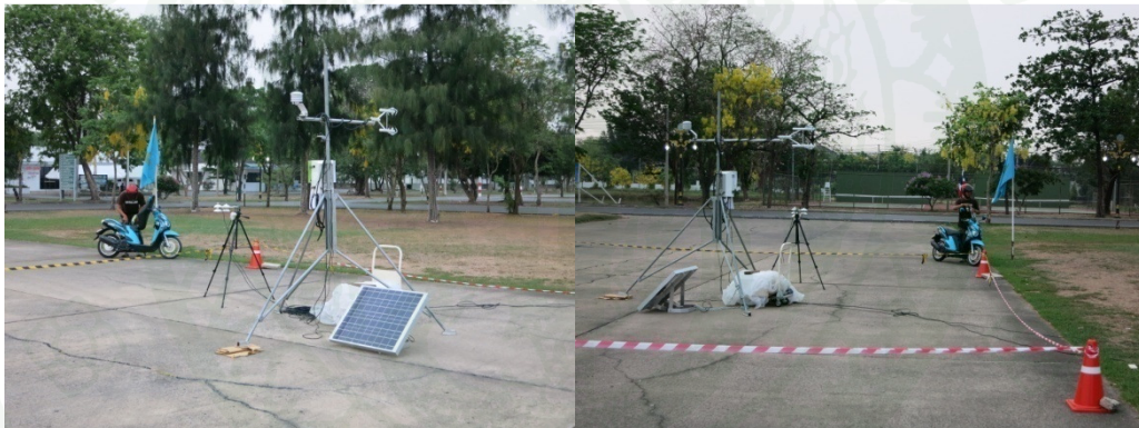
ภาพที่ 10 การติดตั้งเครื่องมือ IRGASON และ NR - 01 ในพื้นที่ซีเมนต์ 75% ต่อพื้นที่สีเขียว 25% บริเวณลานสวนสนาม โรงเรียนนายเรืออากาศ ดอนเมือง (C75% G25%)
