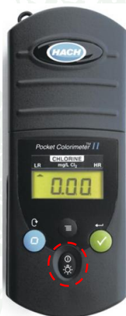
ภาพผนวกที่ ข1 การเปิดเครื่อง Pocket Colorimeter II
