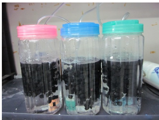
ภาพที่ 3.3 การติดตั้งอุปกรณ์สำหรับการตรวจวัดอัตราการบำบัดไนไตรต์ของตัวกลางพลาสติกที่ผ่านการตรึงเชื้อและคัดเลือกให้เหลือเฉพาะแบคทีเรียกลุ่ม NOB
