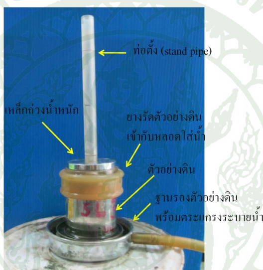
ภาพที่ 31 การต่อตัวอย่างดินเข้ากับอุปกรณ์วัดความนำชลศาสตร์แบบความดันแปรเปลี่ยน
