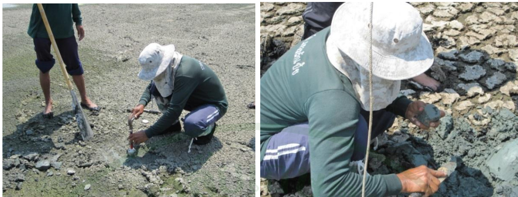
ภาพที่ 28 การเก็บตัวอย่างดินบริเวณท้องบ่อ
