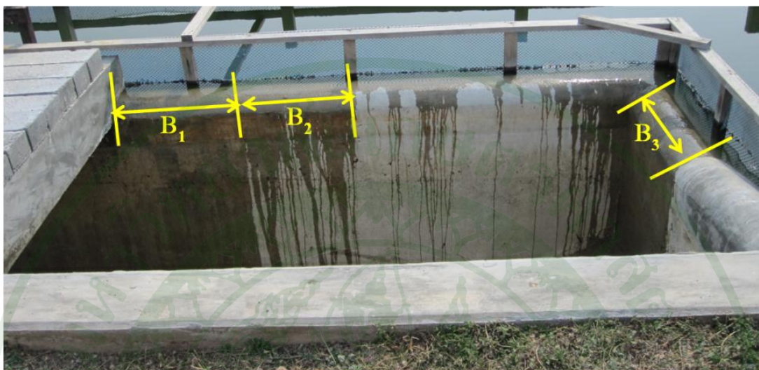
ภาพที่ 43 ช่วงที่น้ำไหลล้นสันฝาย ระดับน้ำมีความสูงเท่ากับความสูงสันฝาย
