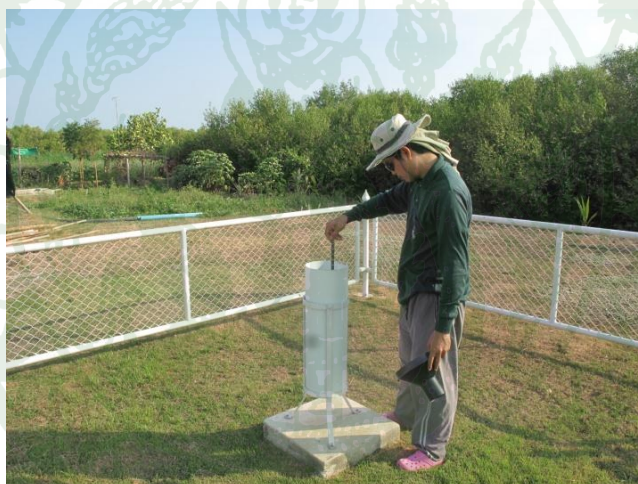
ภาพที่ 25 การวัดปริมาณน้ำฝนของเครื่องวัดน้ำฝนแบบไม่อัตโนมัติ
