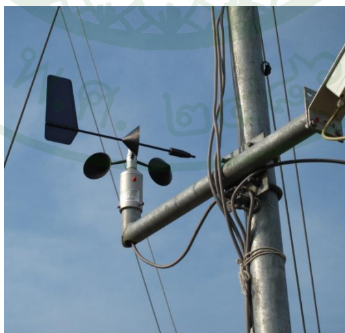
ภาพที่ 5 เครื่องมือวัดความเร็วลม Anemometer
