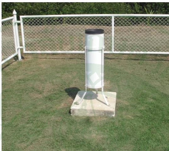
ภาพที่ 2 เครื่องมือวัดน้ำฝนแบบอัตโนมัติ Standard 8-inch rain gauge
