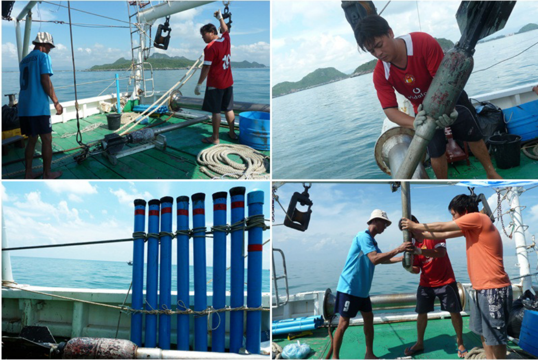
รูป 3.21 การปฏิบัติงานขณะทำการเก็บตัวอย่างตะกอนทะเลด้วย mini-gravity corer ในระหว่างการสำรวจครั้งที่ 1
