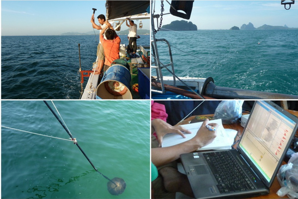
รูป 3.29 การปฏิบัติงานภายในเรือสำรวจ ระบบ metal disk/rod+metal plate (สำรวจครั้งที่ 1)
