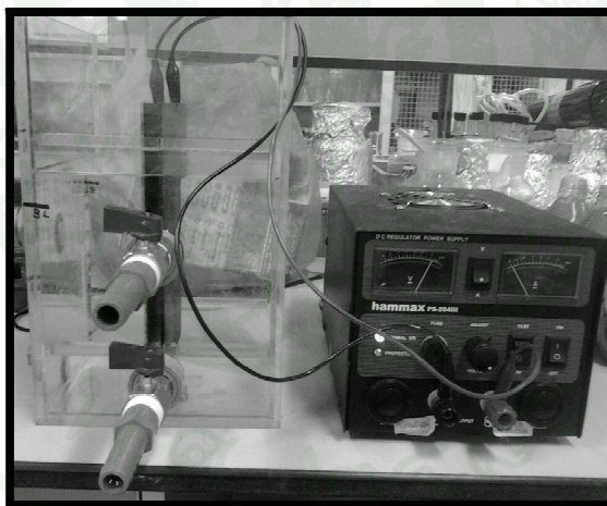
ภาพที่ 7 ตั้งปฏิกิริยาไฟฟ้าเคมีต่อวงจรแบบโมโนโพลาร์เซลล์เดี่ยว
