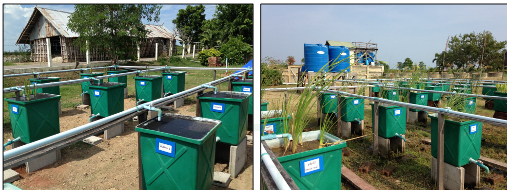
ภาพที่ 45 หน่วยทดลองของระบบน้ำกรองน้ำเสียและระบบพื้นที่ชุ่มน้ำเทียม
