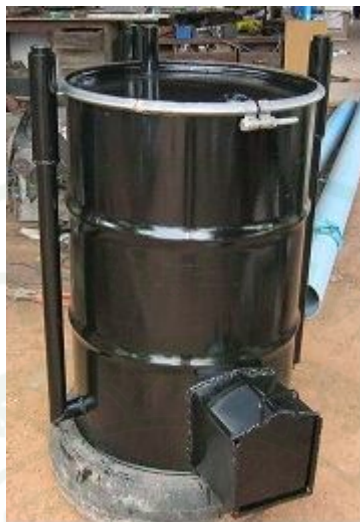
ภาพที่ 42 เตาเผาถ่านแบบถัง ขนาดความจุ 200 ลิตร
