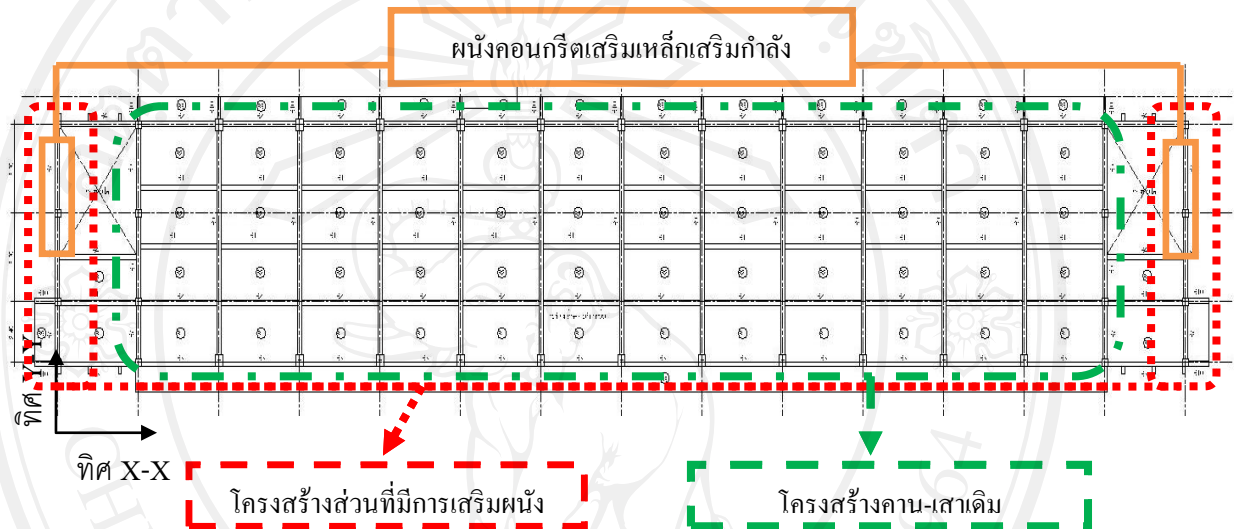
(ก) รูปตัดผนังรับแรงเฉือนที่เสริมกำลังในทิศ Y-Y
