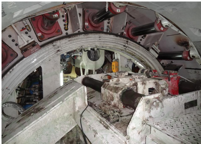
ภาพที่ 10 การทำงานของ Thrust jack เพื่อออกแรงผลักให้หัวเจาะเคลื่อนที่ไปข้างหน้า
