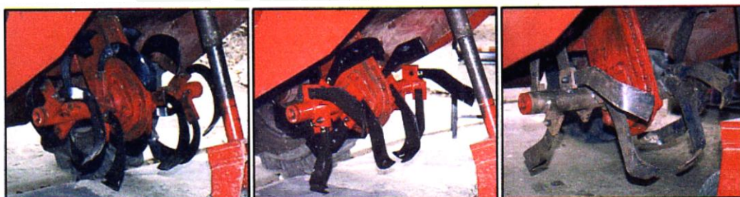
ภาพที่ 27 ลักษณะการติดตั้งไบมีดจอบหมุนกับเพลารองพรวนจอบหมุน
