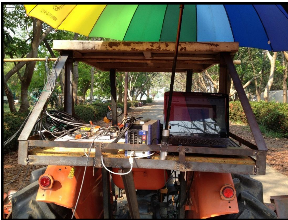
ภาพผนวกที่ ข3 การติดตั้งเครื่องบันทึกข้อมูลเอนกประสงค์ และคอมพิวเตอร์บริเวณหลังรถแทรกเตอร์
