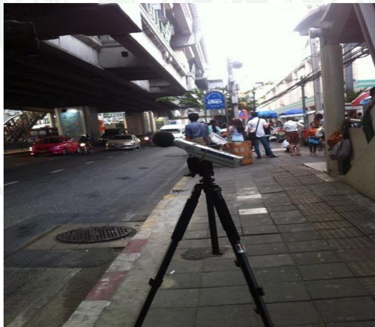
ภาพผนวกที่ ค2 การวัดเสียงบริเวณใต้สถานีรถไฟฟ้า อ่อนนุช
