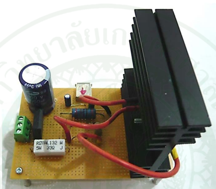
ภาพที่ 82 วงจรชาร์จประจุไฟฟ้าเพื่อทดสอบประสิทธิภาพของระบบ ICPT
