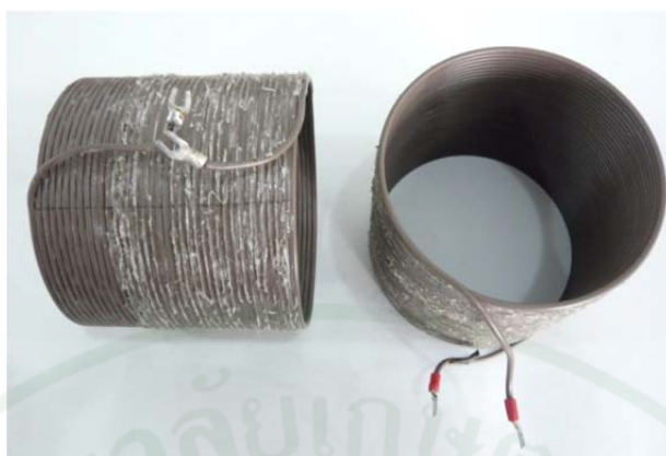
ภาพที่ 60 ขดลวดที่ 1 ขดลวดโซลินอยด์ขนาดเส้นผ่านศูนย์กลาง 10 เซนติเมตร
