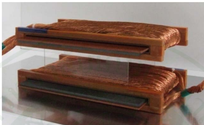
ภาพที่ 8 ตัวอย่างขดลวดแบบ Double-Side Winding Transformer
