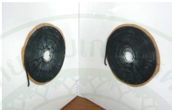
ภาพที่ 62 ขดลวดที่ 3 ขดลวดเกลียวราบแบบกลมขนาดเส้นผ่านศูนย์กลาง 12 เซนติเมตร
