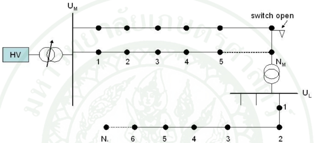
ภาพที่ 13 ระบบจำหน่ายแรงดันต่ำที่มีการเชื่อมต่อแบบเรเดียล
