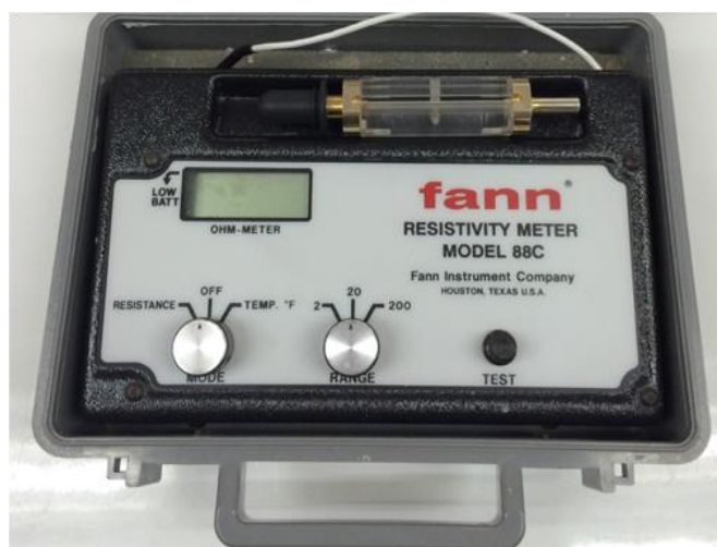
รูปที่ 3.10 เครื่องวิเคราะห์ความต้านทานไฟฟ้า Fann (88C)
