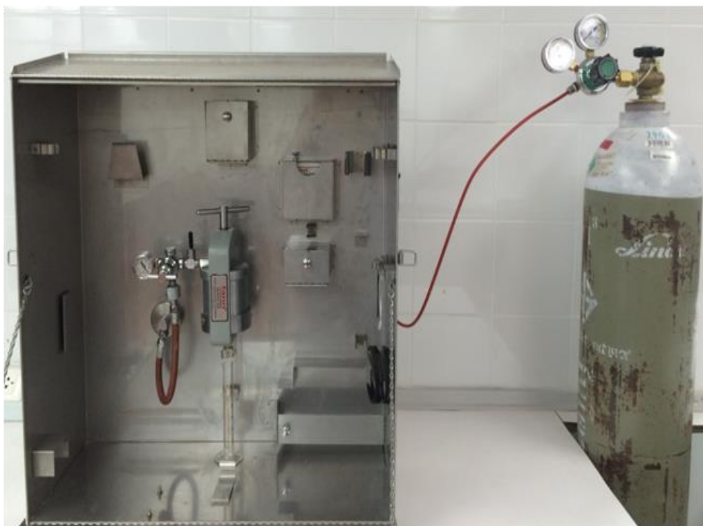
รูปที่ 3.5 เครื่องวิเคราะห์การซึมผ่าน Fann (SERIES 300)
