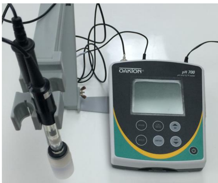
รูปที่ 3.7 เครื่องวิเคราะห์ความเป็นกรด-ด่าง OAKTON (pH 700)
