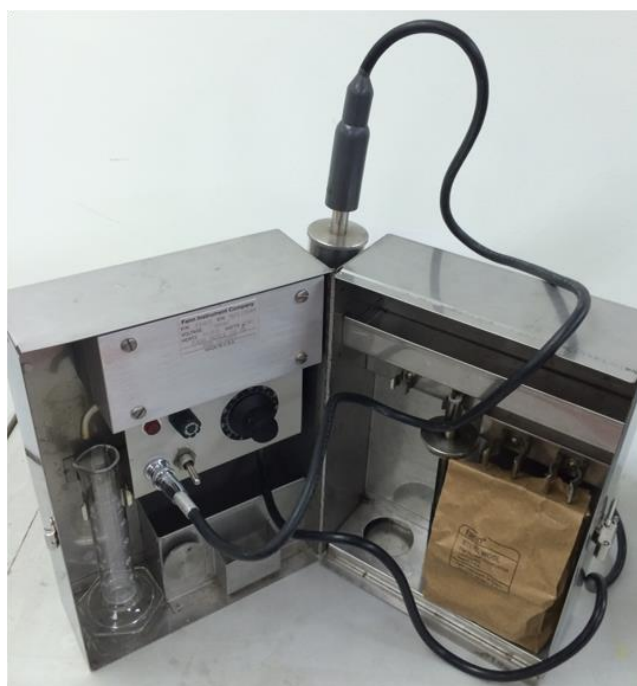
รูปที่ 3.8 เครื่องวิเคราะห์ปริมาณของแข็ง Fann (MODEL 50 ml)
