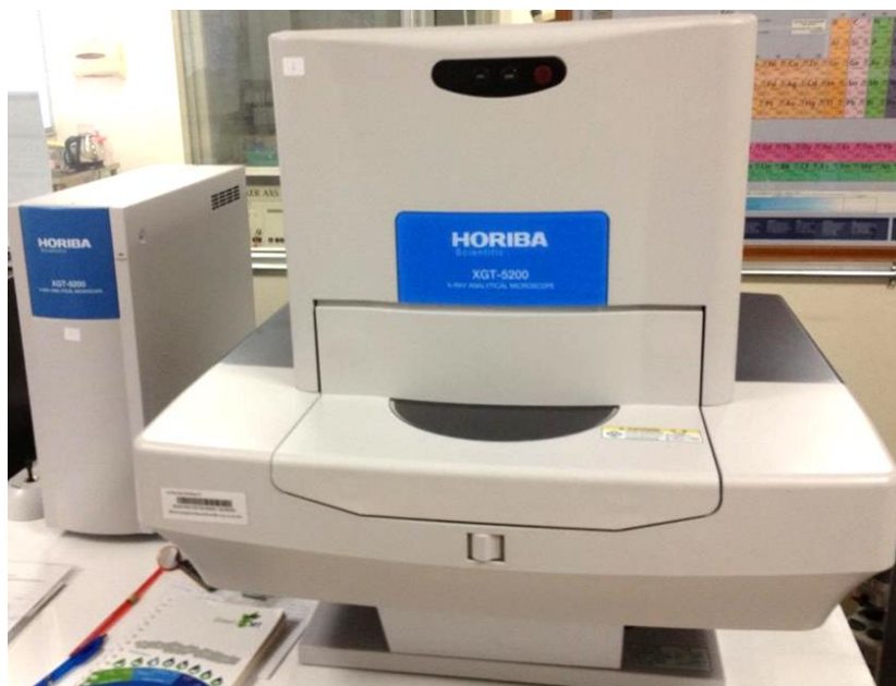
รูปที่ 3.1 เครื่องวิเคราะห์ส่วนประกอบทางเคมีด้วย X-ray Fluorescence Horiba (ED)
