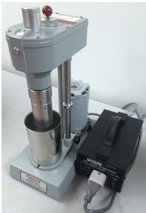
รูปที่ 3.4 เครื่องวิเคราะห์ความหนืด จุกคราก และ gel strength fann (35SA 115-Volt)
