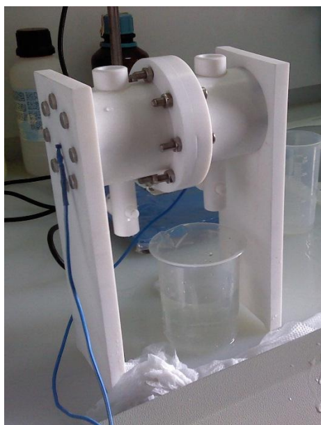
(a) Reactor แบบ double tank
