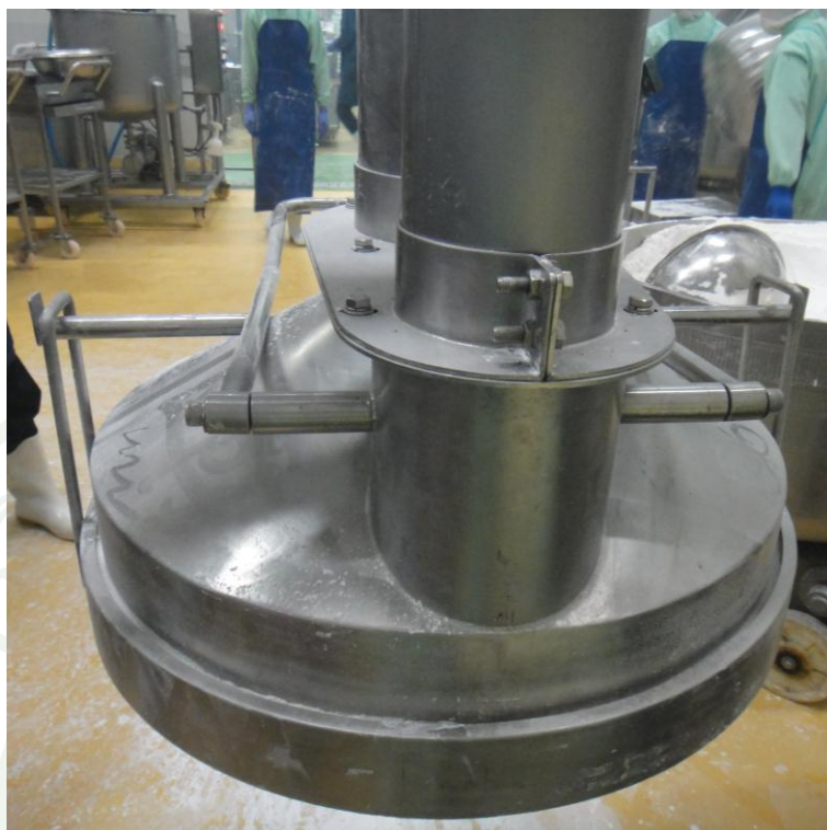
ภาพที่ 29 Powder dust collector unit ดัชนีการมองแบบหลัง
