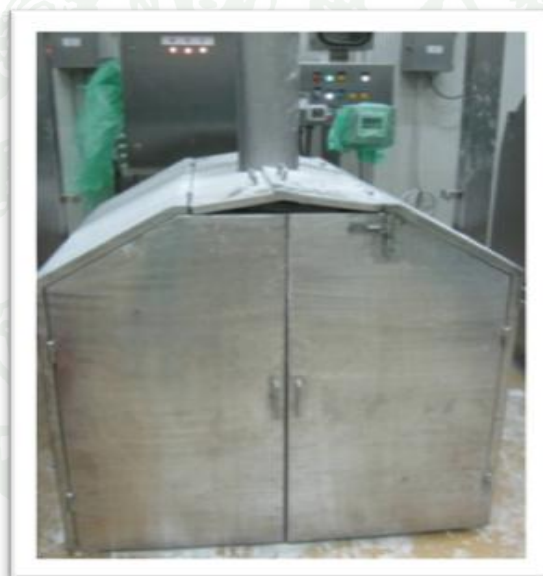
ภาพที่ 12 ตู้ครอบกันแป้งฟุ้งกระจาย
