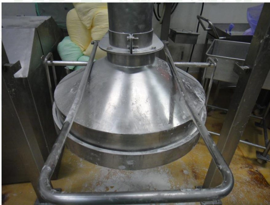
ภาพที่ 28 Powder dust collector unit ลักษณะการมองแบบด้านหน้า (Front view)
