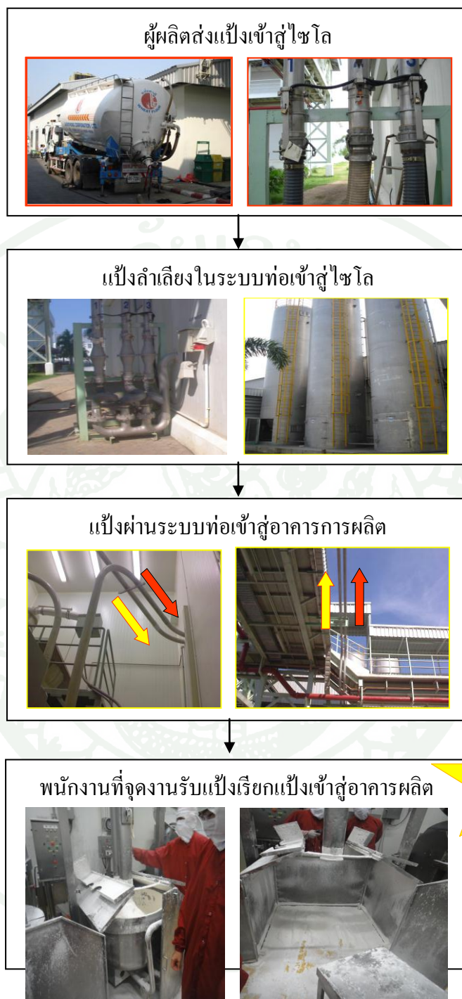
ภาพที่ 10 กระบวนการรับแป้งในพื้นที่อาคารผลิต
