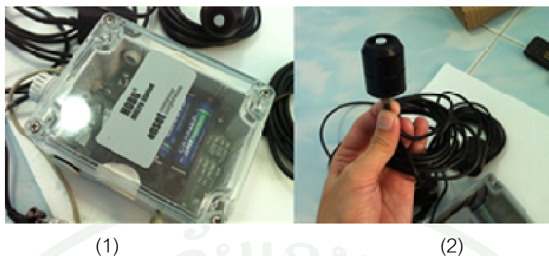
ภาพที่ 38 อุปกรณ์บันทึกข้อมูลด้านค่าความส่องสว่าง
