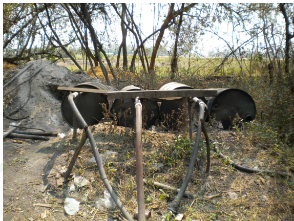
ภาพที่ 17 แหล่งกำเนิดน้ำอาศัยพลังงานเชื้อเพลิงจากฟืน พร้อมท่อสำหรับต่อน้ำไอน้ำผ่านเข้าสู่โรงเรือนเพื่ออบไอน้ำกำจัดเชื้อปนเปื้อนในภายในโรงเรือน ก่อนการเพาะเห็ดฟาง
