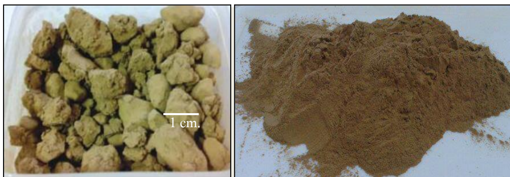
ภาพที่ 16 ตะกอนดินจากกระบวนการผลิตน้ำเพื่อหล่อเย็นของโรงไฟฟ้าแก่งคอย 2 จังหวัดสระบุรี
