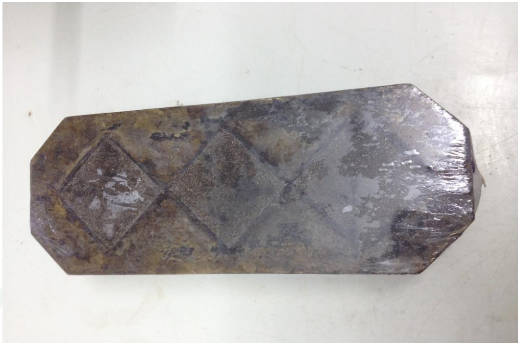
ภาพที่ 11 ขั้นตอนการหุ้มแบบหล่อตัวอย่างด้วยพลาสติกก่อนนำเข้าตู้อบ
