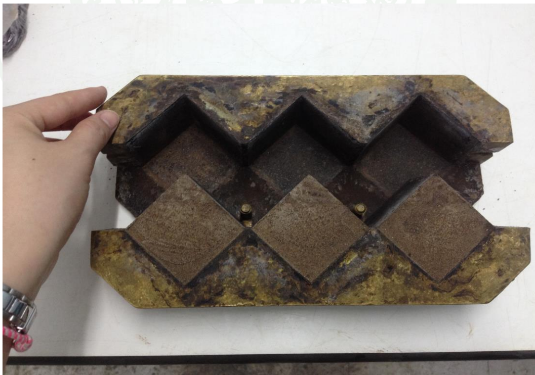
ภาพที่ 12 ขั้นตอนการแกะตัวอย่างออกจากแบบหล่อ
