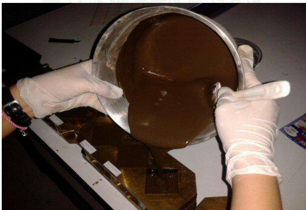
ภาพที่ 10 ขั้นตอนการเทจีโอโพลิเมอร์ลงในแบบหล่อตัวอย่าง
