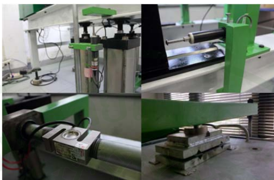
ภาพที่ 79 อุปกรณ์สำหรับการตรวจวัดค่าแรงและการเคลื่อนที่ทั้งทางแนวราบและแนวตั้ง
