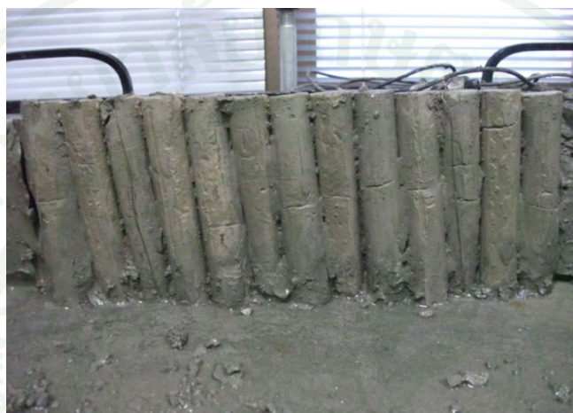
ภาพที่ 145 ลักษณะการพิบัติของตัวอย่างดินเหนียวสร้างใหม่ที่ปรับปรุงคุณภาพด้วยเสาเข็มดินซีเมนต์แบบ LWC ที่น้ำหนักบรรทุก 5.9 kPa
