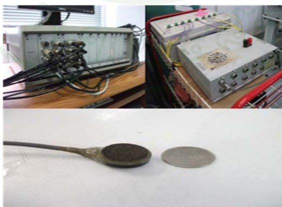
ภาพที่ 80 อุปกรณ์สำหรับการเก็บข้อมูลทดสอบ (Data Logger) และอุปกรณ์วัดแรงดันน้ำ
