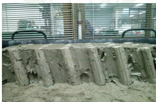
ภาพที่ 138 ลักษณะการพิบัติของตัวอย่างดินเหนียวสร้างใหม่ที่ปรับปรุงคุณภาพด้วยเสาเข็มดินซีเมนต์แบบ SSC ที่น้ำหนักบรรทุกทุก 11.8 kPa
