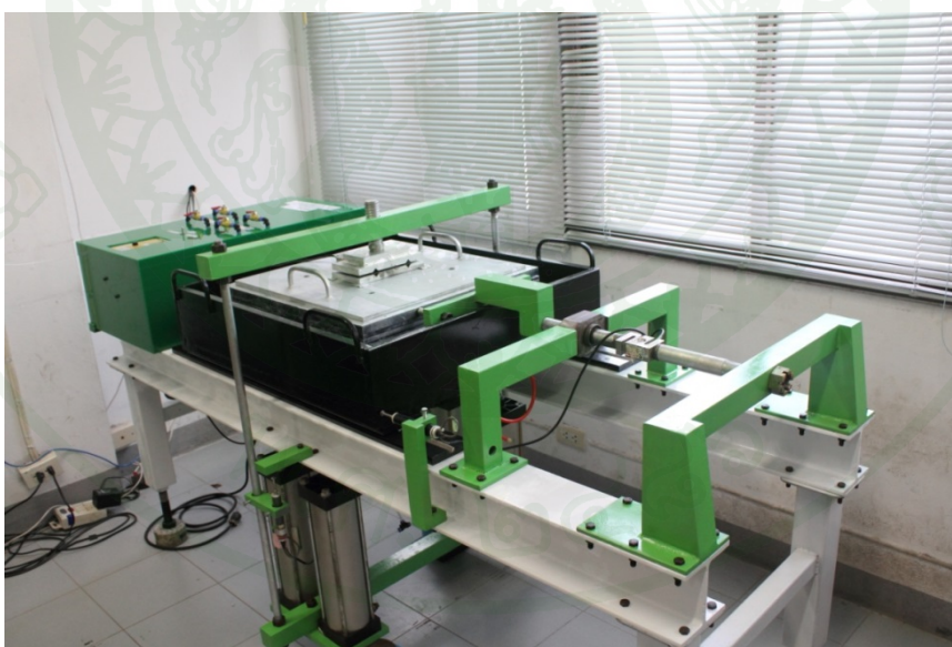
ภาพที่ 71 เครื่องมือการทดสอบการเคียนตรงอย่างง่ายขนาดใหญ่เมื่อประดิษฐ์เสร็จสิ้นแล้ว
