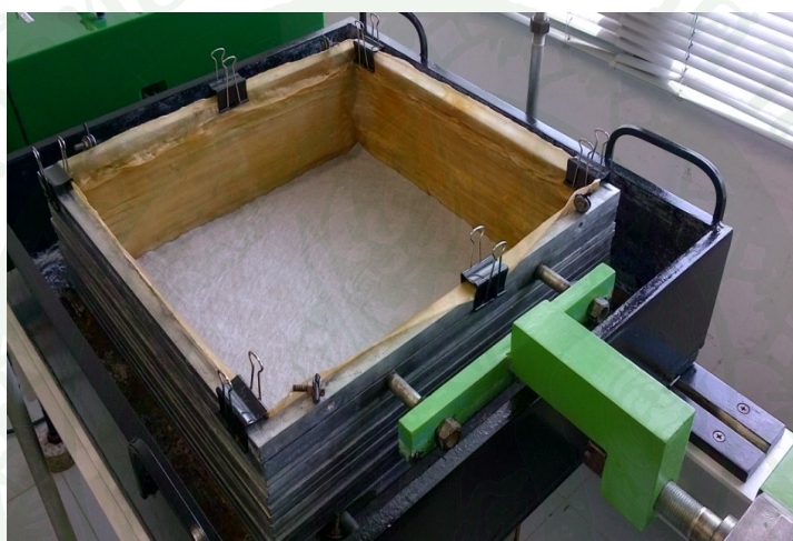
ภาพที่ 77 ลักษณะของอุปกรณ์หุ้มตัวอย่างที่ติดตั้งพร้อมกับแผ่นยางและแผ่นใยสังเคราะห์
