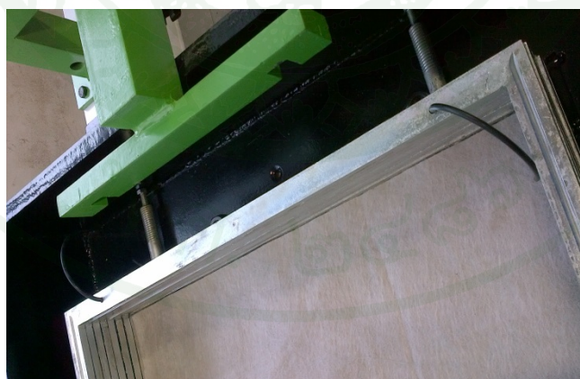
ภาพที่ 105 การประกอบชิ้นส่วนของ Rigid Stack Ring ในขั้นแรก
