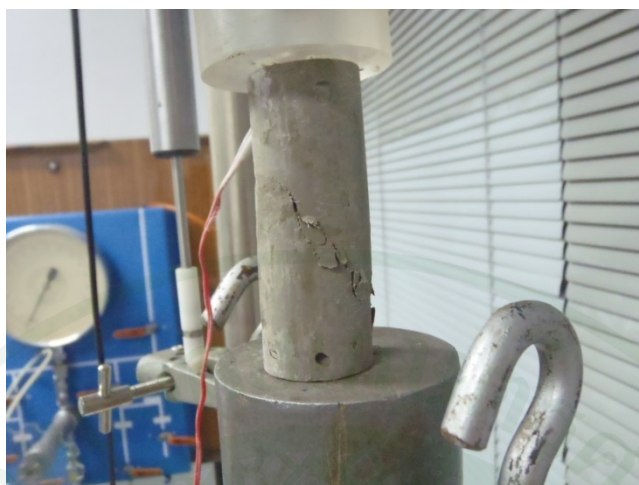
ภาพผนวกที่ ก2 ลักษณะการพบัติของแท่งดินซีเมนต์เมื่อเสร็จสิ้นการทดสอบแรงอัด
