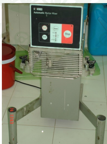
ภาพที่ 97 การผสมดินและปูนซีเมนต์ที่เตรียมไว้ด้วยเครื่องผสม
