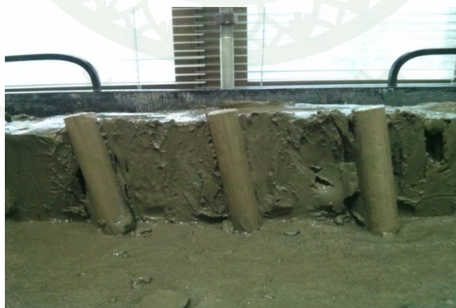
ภาพที่ 154 ลักษณะการพิบัติของตัวอย่างดินเหนียวสร้างใหม่ที่ปรับปรุงคุณภาพด้วยเสาเข็มดินซีเมนต์แบบ TWC ที่น้ำหนักรบรรทุก 11.8 kPa
