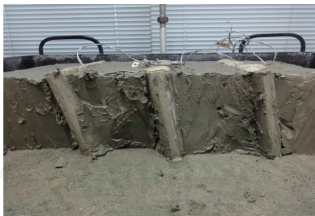
ภาพที่ 155 ลักษณะการบีบอัดของตัวอย่างดินเหนียวสร้างใหม่ที่ปรับปรุงคุณภาพด้วยเสาเข็มดินซีเมนต์แบบ TWC ที่น้ำหนักรบรรทุก 23.6 kPa
