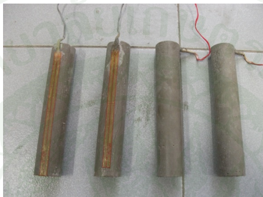
ภาพที่ 98 การติดตั้ง Strain Gauge ลงบนผิวของตัวอย่างดินซีเมนต์
