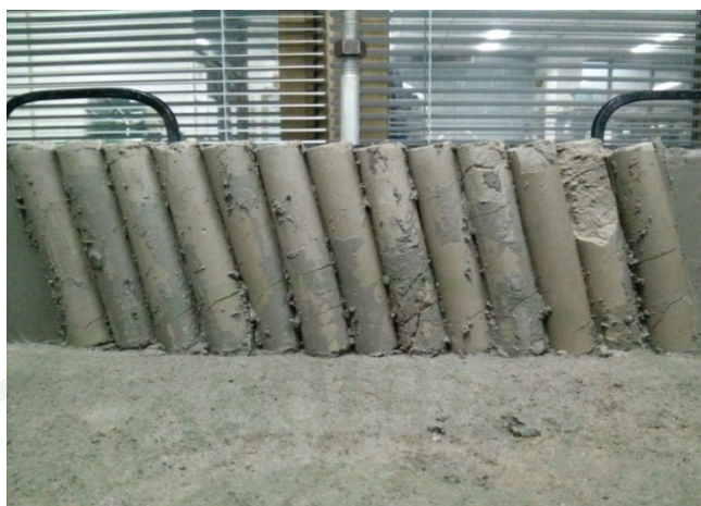
ภาพที่ 147 ลักษณะการพิบัติของตัวอย่างดินเหนียวสร้างใหม่ที่ปรับปรุงคุณภาพด้วยเสาเข็มดินซีเมนต์แบบ LWC ที่น้ำหนักบรรทุก 23.6 kPa
