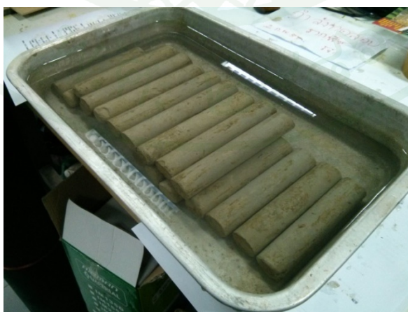
ภาพที่ 99 การนำตัวอย่างแท่งดินซีเมนต์มาบ่มในน้ำ
