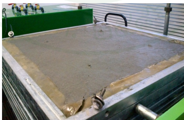
ภาพที่ 109 การเตรียมตัวอย่างดินเหนียวสร้างใหม่ลงไปบนชั้น Rigid Stack Ring
