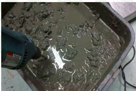
ภาพที่ 102 การเพิ่มน้ำเข้าไปเพื่อให้ได้ปริมาณความชื้นที่ต้องการ
