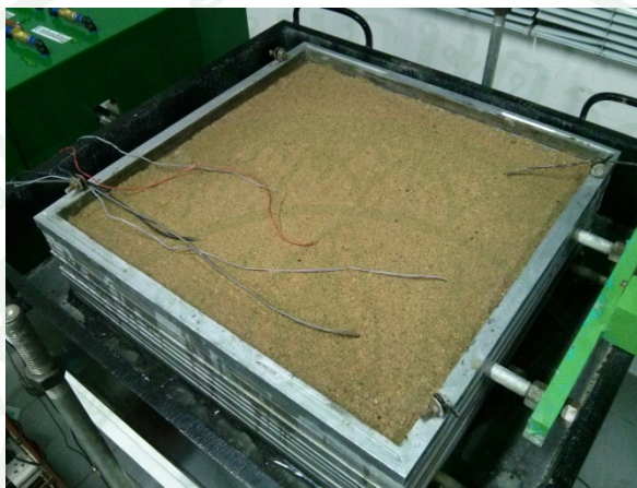
ภาพที่ 118 การปรับระดับของตัวอย่างด้วยทรายละเอียด
