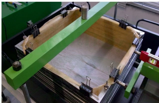
ภาพที่ 108 การติดตั้งแผ่นยางหุ้มตัวอย่าง (Rubber Membrane) และแผ่นใยสังเคราะห์ (Geotextile)
