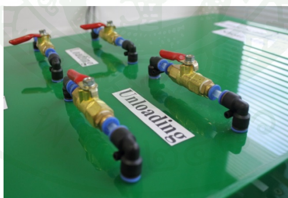
ภาพที่ 75 อุปกรณ์สำหรับการควบคุมการให้น้ำหนักบรรทุกแก่ตัวอย่างทดสอบ
