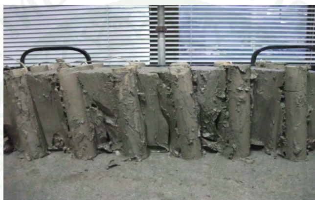
ภาพที่ 137 ลักษณะการพิบัติของตัวอย่างดินเหนียวสร้างใหม่ที่ปรับปรุงคุณภาพด้วยเสาเข็มดินซีเมนต์แบบ SSC ที่น้ำหนักบรรทุกทุก 5.9 kPa
