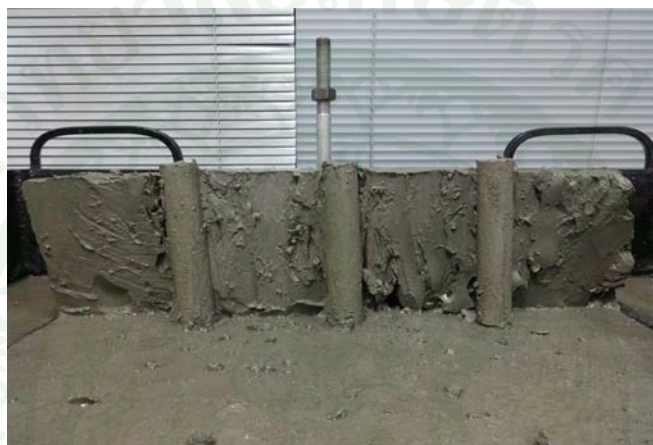
ภาพที่ 153 ลักษณะการพิบัติของตัวอย่างดินเหนียวสร้างใหม่ที่ปรับปรุงคุณภาพด้วยเสาเข็มดินซีเมนต์แบบ TWC ที่น้ำหนักรบรรทุก 5.9 kPa
