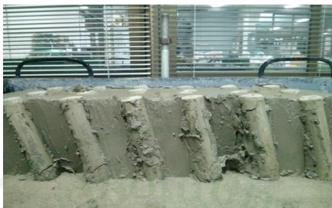
ภาพที่ 139 ลักษณะการบีบตัวของตัวอย่างดินเหนียวสร้างใหม่ที่ปรับปรุงคุณภาพด้วยเสาเข็มดินซีเมนต์แบบ SSC ที่น้ำหนักบรรทุกทุก 23.6 kPa
