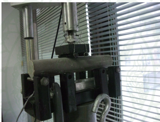
ภาพผนวกที่ ข1 การติดตั้งแท่งเสาเข็มดินซีเมนต์เพื่อเตรียมการทดสอบแรงดัด
