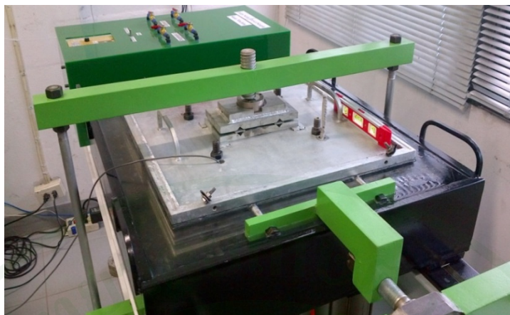
ภาพที่ 112 การทดสอบตัวอย่างในระหว่างขั้นตอนการอัดตัวคายน้ำ
