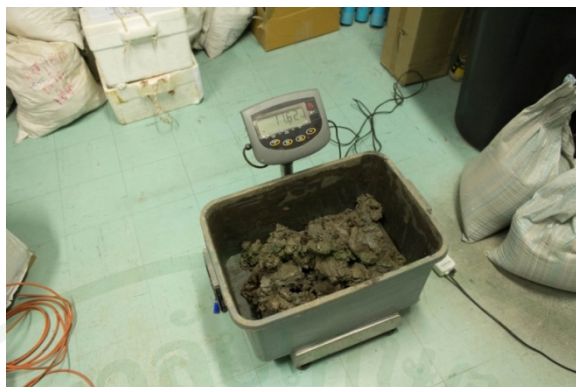
ภาพที่ 101 การชั่งน้ำหนักดินเพื่อเตรียมการทำตัวอย่างดินเหนียวสร้างใหม่
