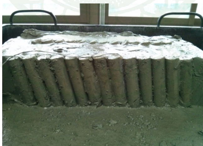
ภาพที่ 146 ลักษณะการพิบัติของตัวอย่างดินเหนียวสร้างใหม่ที่ปรับปรุงคุณภาพด้วยเสาเข็มดินซีเมนต์แบบ LWC ที่น้ำหนักบรรทุก 11.8 kPa
