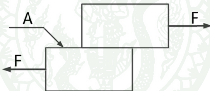
ภาพที่ 3 นิยามของความเค้นเฉือน
