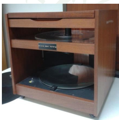
ภาพที่ 30 วิธีการทดสอบค่าการทิ้งตัว
