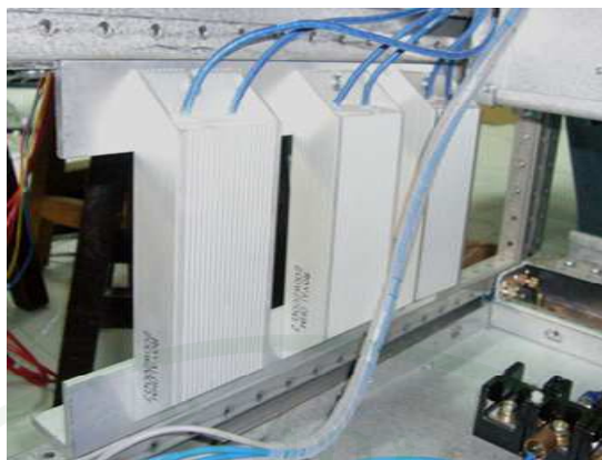
ภาพที่ 40 ตัวต้านทานสำหรับจำกัดกระแสอัดประจุ
