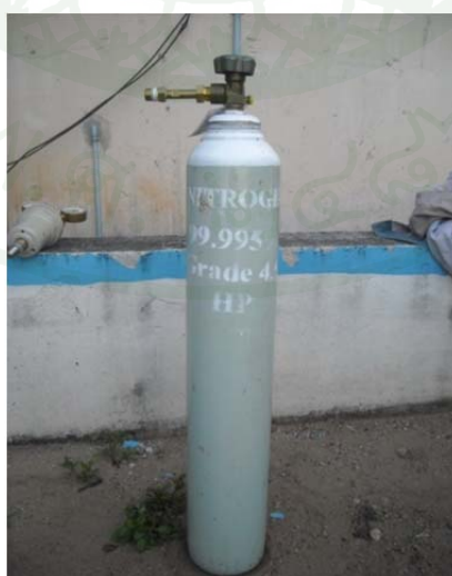
ภาพที่ 112 ถังไนโตรเจนขนาดเล็กที่ใช้ตั้งค่าอุปกรณ์ลดแรงดัน
