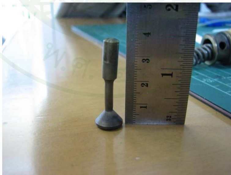
ภาพที่ 139 ลินวาล์วของ Regulator ที่เสียรูป
