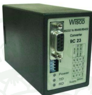
ภาพที่ 97 แสดงอุปกรณ์แปลงสัญญาณ RC 23
