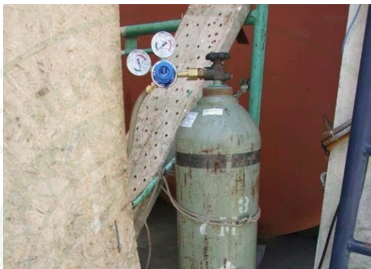
ภาพที่ 147 ถังไนโตรเจนที่ใช้ทดสอบการรั่วของท่อทองแดง
