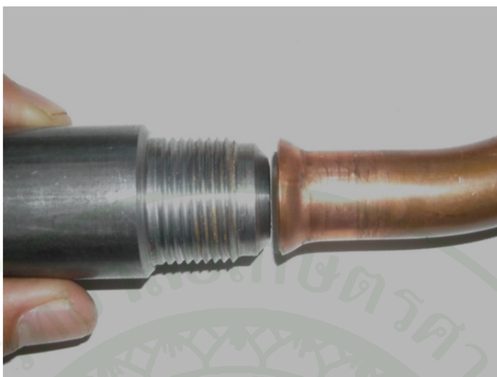
ภาพที่ 40 ข้อต่อต้องรับเข้ากับข้อต่อชุดท่อโค้งทองแดง (Loop pipe)
