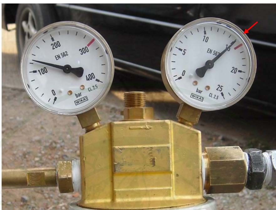
ภาพที่ 115 ค่าแรงดันด้านออกทำการปรับตั้งค่าไปที่ 15 บาร์
