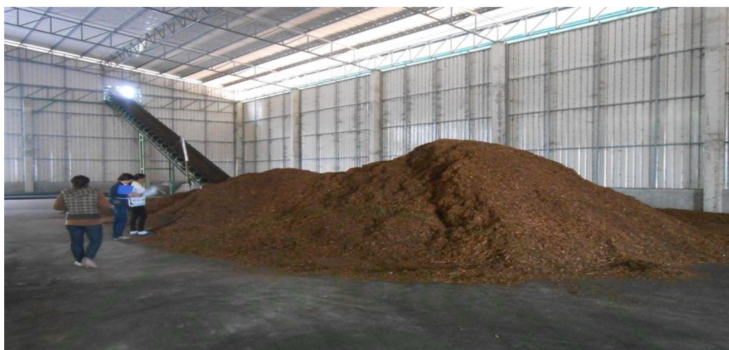
ภาพที่ 9 กระบวนการป้อนชีวมวลเข้าสู่เครื่อง Gasifier ที่มา: โรงไฟฟ้าเพชรภูพาน จังหวัดสกลนคร (2556)
