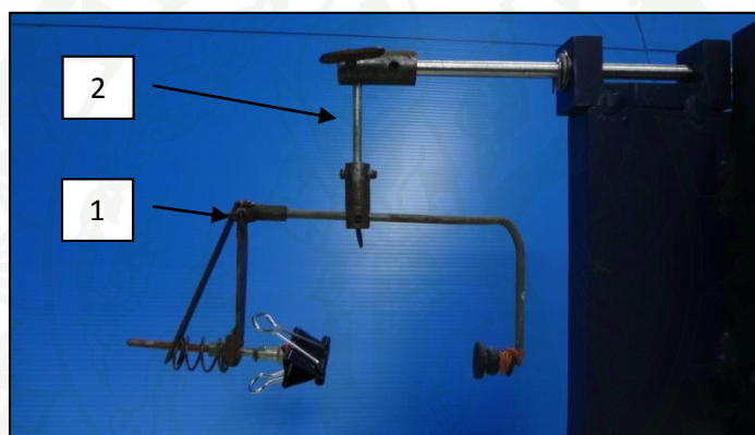
ภาพที่ 4 ลักษณะอุปกรณ์จับมั่งคุด หมายเลข 1 คือ อุปกรณ์จับมั่งคุด และ 2 คือ แขนเพลลา
