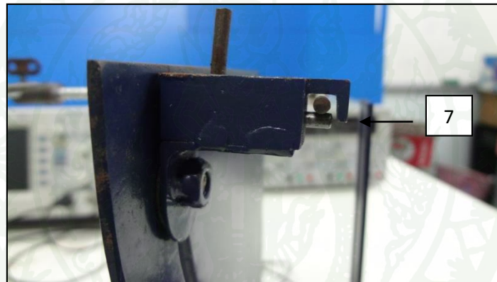
ภาพที่ 7 ลักษณะสลักยึดแขนแกว่ง หมายเลข 7 คือ ชูตสลักยึดแขนแกว่ง
