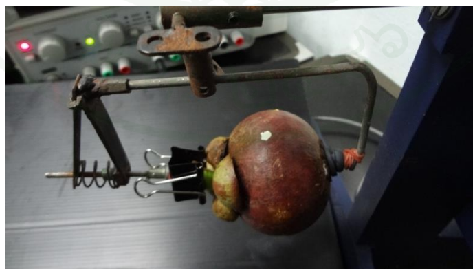
ภาพที่ 8 การจับมั่งคุดตัวอย่างด้วยอุปกรณ์ยึดมั่งคุด
