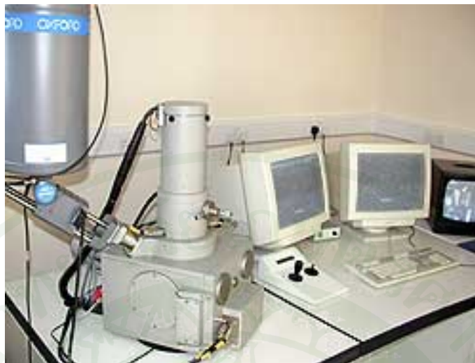
ภาพที่ 18 กล้องจุลทรรศน์อิเล็กตรอนแบบส่องกราด (Scanning Electron Microscope, SEM) ยี่ห้อ JEOL รุ่น JSM-5410 ต่อกับชุดเอ็กซ์เรย์สเปกโตรสโคปีแบบกระจายพลังงาน (Energy Dispersive X-Ray Spectrometer, EDS) ยี่ห้อ Oxford รุ่น ISIS 300
