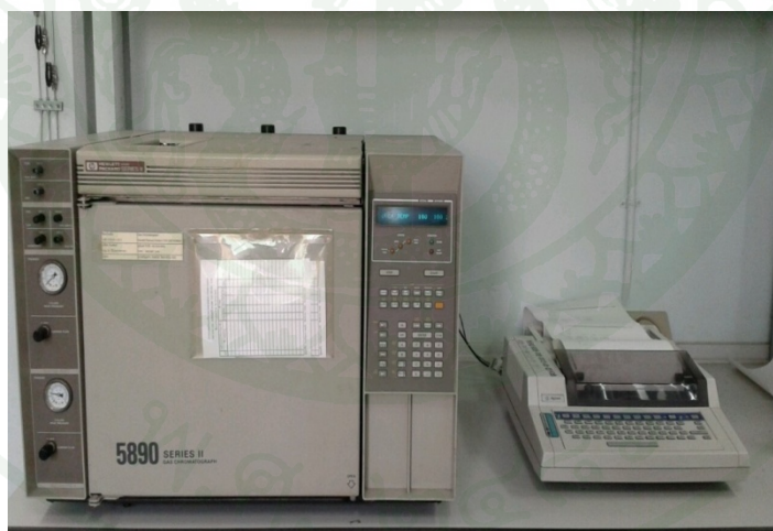
ภาพที่ 19 เครื่องก๊าซโครมาโตกราฟ (Gas Chromatograph) ยี่ห้อ Hewlett Packard รุ่น 5890 Series II ประกอบด้วยดีเทคเตอร์ ชนิด FID และคอลัมน์ชนิด HP-1
