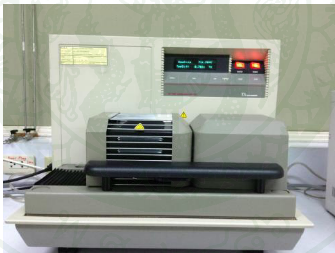
ภาพที่ 15 เครื่อง Thermal Analysis (DTA/TGA) ยี่ห้อ TA Instrument รุ่น STD 2960
