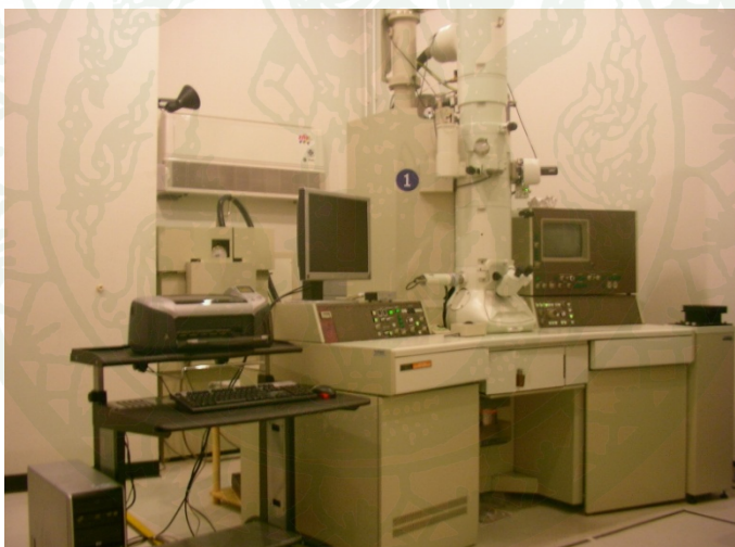
ภาพที่ 17 กล้องจุลทรรศน์อิเล็กตรอนชนิดส่องผ่าน (TEM) ยี่ห้อ JEOL รุ่น JEM-2100 LaB6
