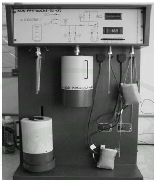
ภาพที่ 14 เครื่องวิเคราะห์พื้นที่ผิว ยี่ห้อ Quantachrome Instruments รุ่น Autosorb-1-C
