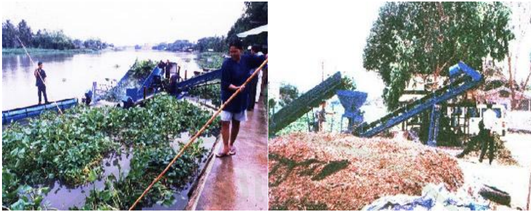
ภาพที่ 4 เครื่องเก็บผักตบชวาแบบติดตั้งริมฝั่งระบบสายพานลำเลียง
