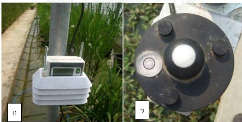
ภาพที่ 5 เครื่องตรวจวัดสภาพอากาศ (ก) กล่องบันทึกข้อมูล ที่มีเครื่องวัดอุณหภูมิ และความชื้นสัมพัทธ์ (ข) เครื่องวัดความเข้มแสง
