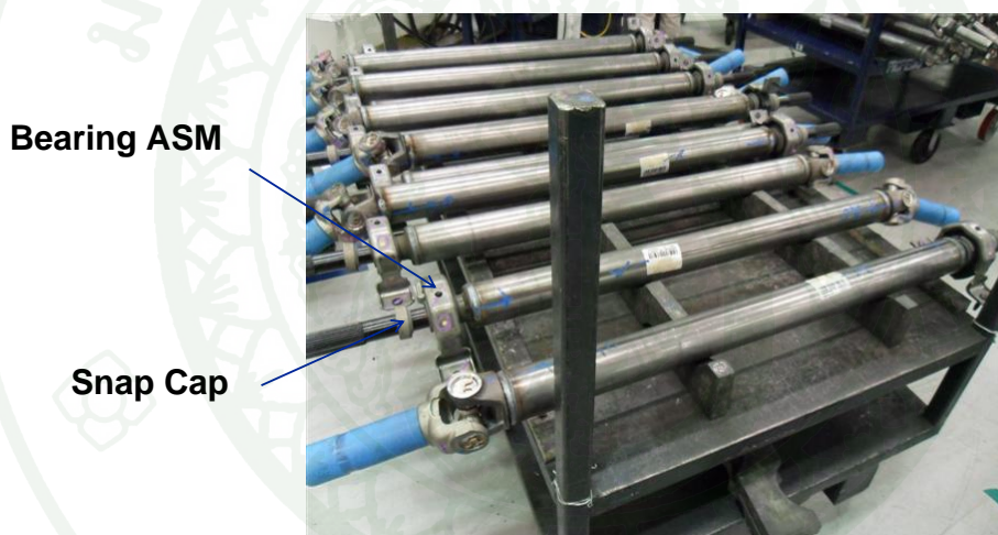
ภาพที่ 23 ชิ้นงานท่อนด้านหน้าที่ผ่านกระบวนการอัด Bearing ASM และ Snap Cap
