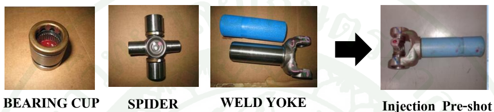
ภาพที่ 20 ชิ้นงานที่มีการฉีดพลาสติกแบบ Pre-shot
