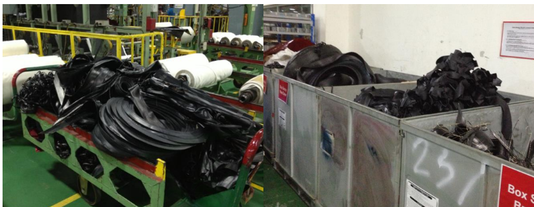
ภาพที่ 10 ของเสียที่เกิดจากกระบวนการผลิตของกระบวนการผลิตยางรถยนต์
