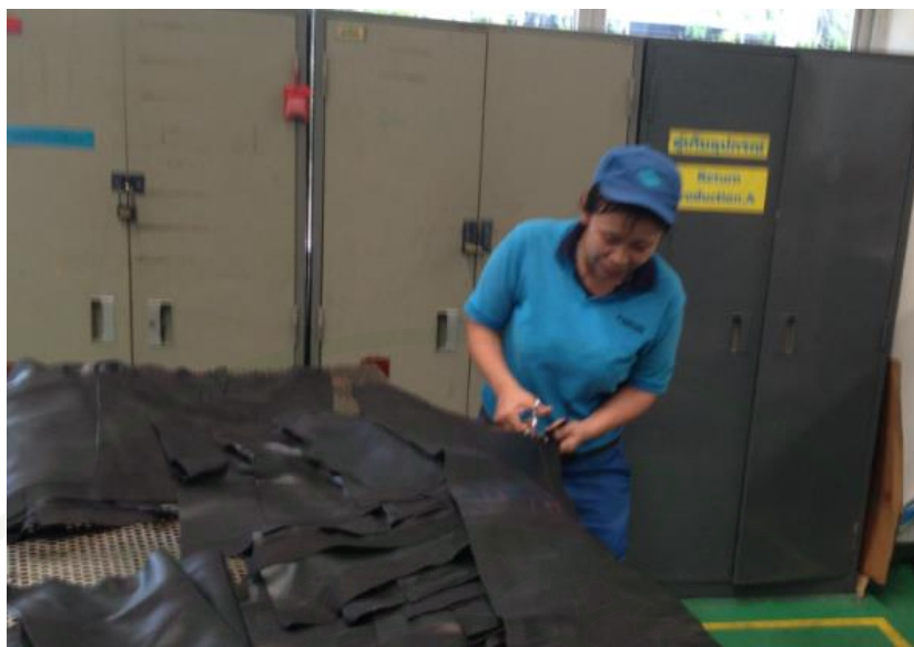
ภาพที่ 16 การแยกเศษวัสดุที่เหลือหรือของเสียจากกระบวนการผลิตเพื่อเตรียมไป Recycle
