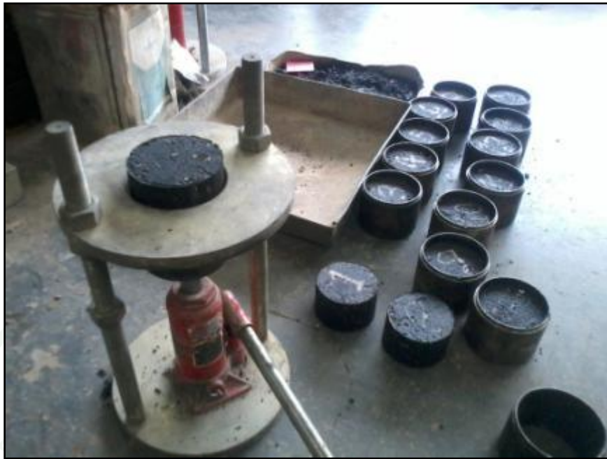
ภาพผนวกที่ ง43 แม่แรงแกะก้อนตัวอย่างออกจาก Mold
