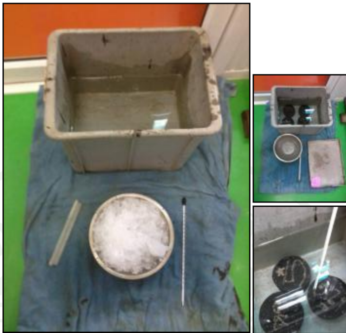
ภาพผนวกที่ ๕3 การแช่ตัวอย่างในน้ำอุณหภูมิ 25 °C เวลา 1 ชั่วโมง การทดสอบ Strength Index
