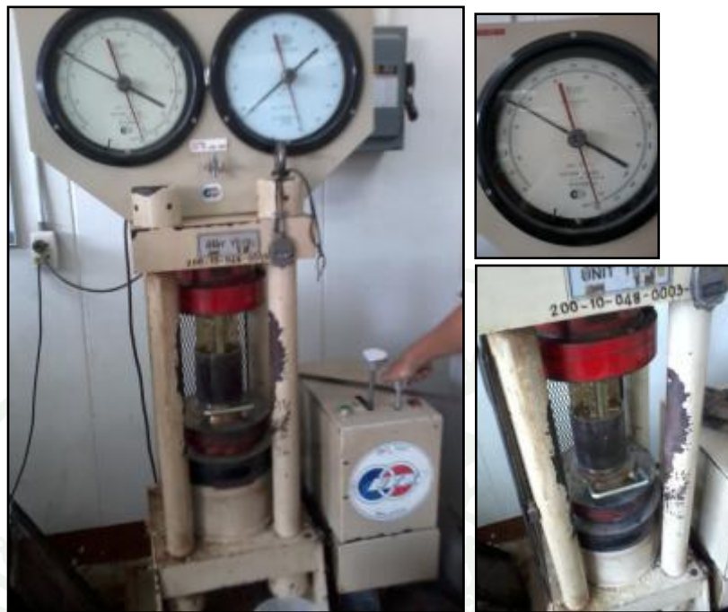
ภาพผนวกที่ ๔๙ การกดก้อนตัวอย่าง ทดสอบ Strength Index
