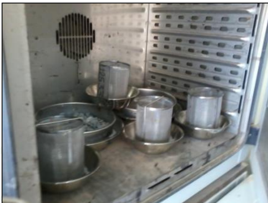
ภาพผนวกที่ ง33 การนำตัวอย่างเข้าตู้อบ ของการทดสอบ Soundness
