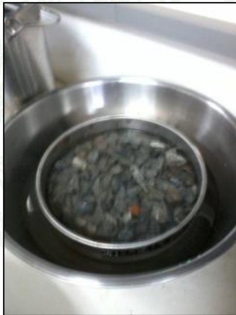
ภาพผนวกที่ ง30 การนำมวลรวมหยาบแช่โซเดียมซัลเฟต ของการทดสอบ Soundness
