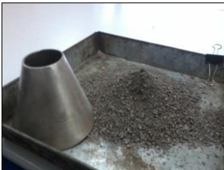
ภาพผนวกที่ ง19 การตรวจสอบหินฝุ่น ค้างตะแกรงเบอร์ 4 ว่าอยู่ในสถานะอิมพัลฟ์เวนท์
