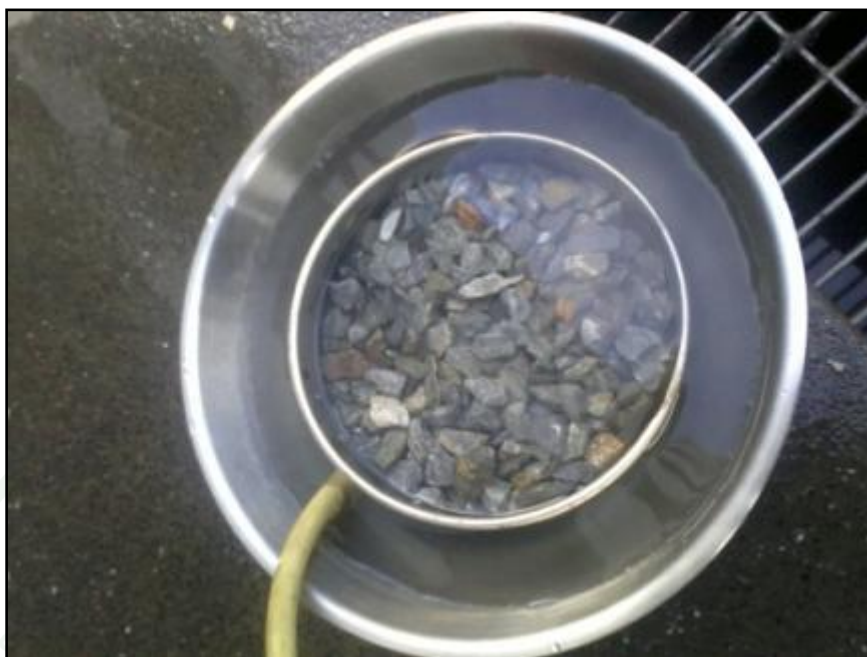
ภาพผนวกที่ ง35 การล้างตัวอย่าง หลังจากแฉะสารละลายโซเดียมซัลเฟต
