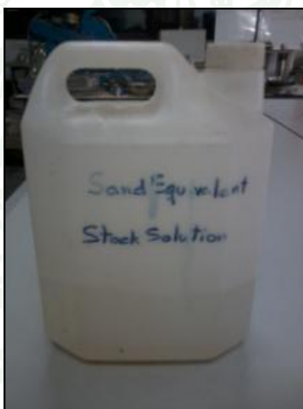
ภาพผนวกที่ ง8 สารละลาย Stock Solution สำหรับการทดสอบ Sand Equivalent
