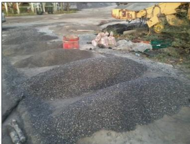
ภาพผนวกที่ ง1 การเก็บหินตัวอย่าง (Hot Bin) จากโรงงาน
