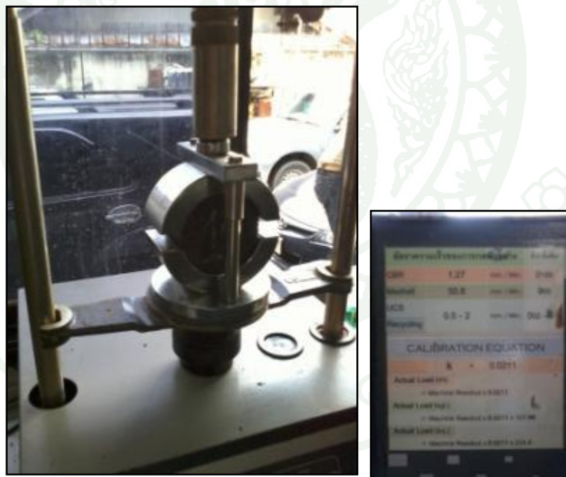
ภาพผนวกที่ ง46 การทดสอบ Marshall เพื่อหา Stability และ Flow
