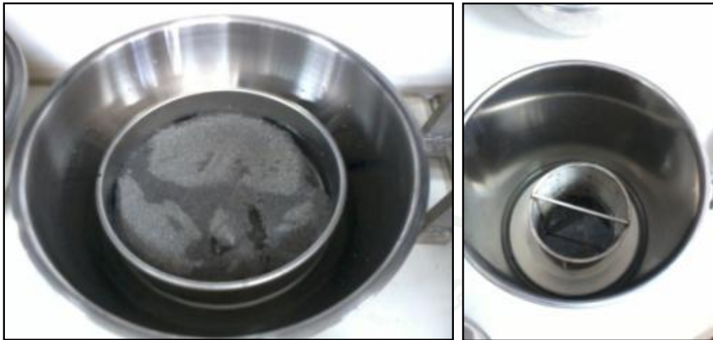
ภาพผนวกที่ ง31 การนำมวลรวมละเอียดแซะโซเดียมซิลเฟต ของการทดสอบ Soundness
