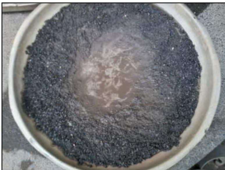
ภาพผนวกที่ ง17 การปล่อยให้หิน อยู่ในสภาวะอิมตัวผิวแห้ง ของหินฝุ่น ค้ำตะแกรงเบอร์ 4
