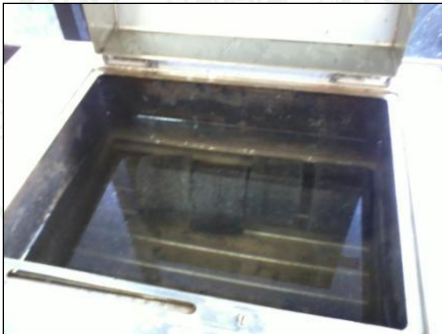
ภาพผนวกที่ ง44 เครื่องต้มตัวอย่างที่ อุณหภูมิ 60 °C เป็นเวลา 30 นาที
