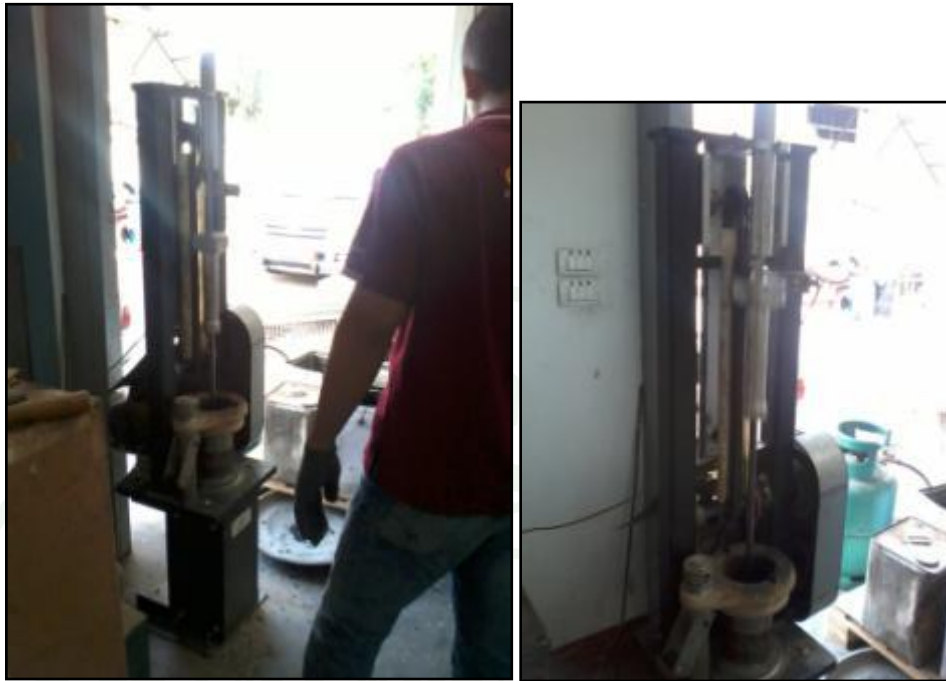
ภาพผนวกที่ ๔๑ การเตรียมก้อนตัวอย่างเพื่อทำการทดสอบ Marshall
