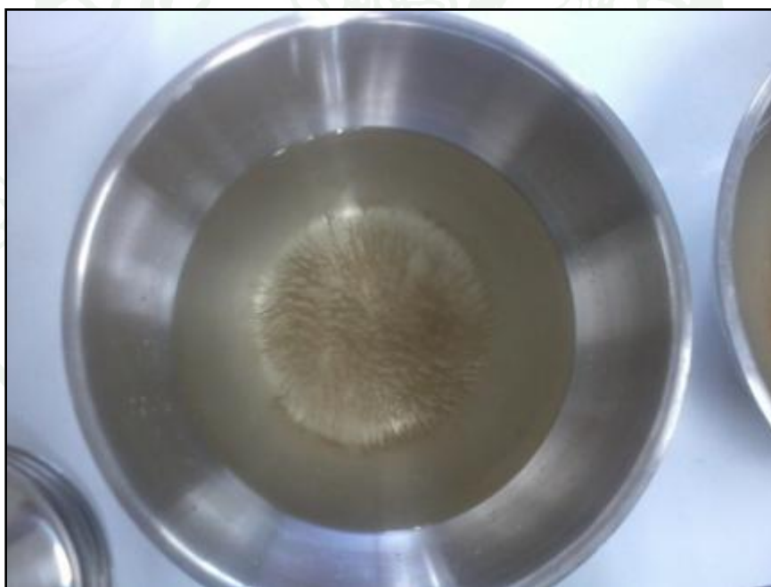
ภาพผนวกที่ ง34 ลักษณะสารละลายโซเดียมซิลเฟต หลังจากแช่แล้ว 5 รอบ
