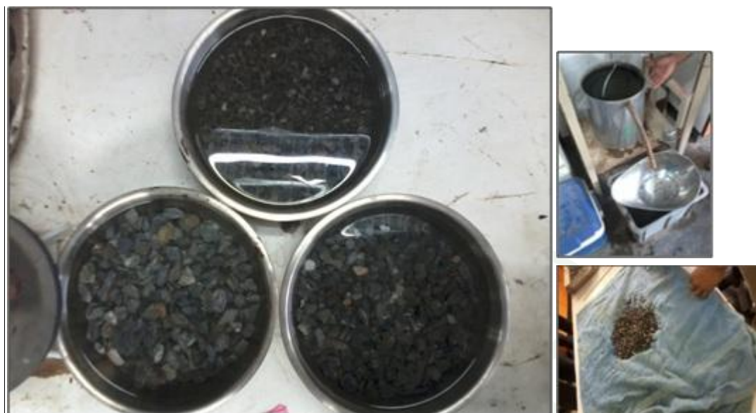
ภาพผนวกที่ ๖5 การหาความถ่วงจำเพาะของหิน 3/4" , 1/2" , 3/8"
