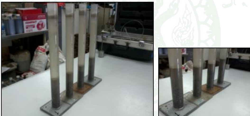
ภาพผนวกที่ ๑๐ การรอตตะกอนของตัวอย่าง Sand Equivalent
