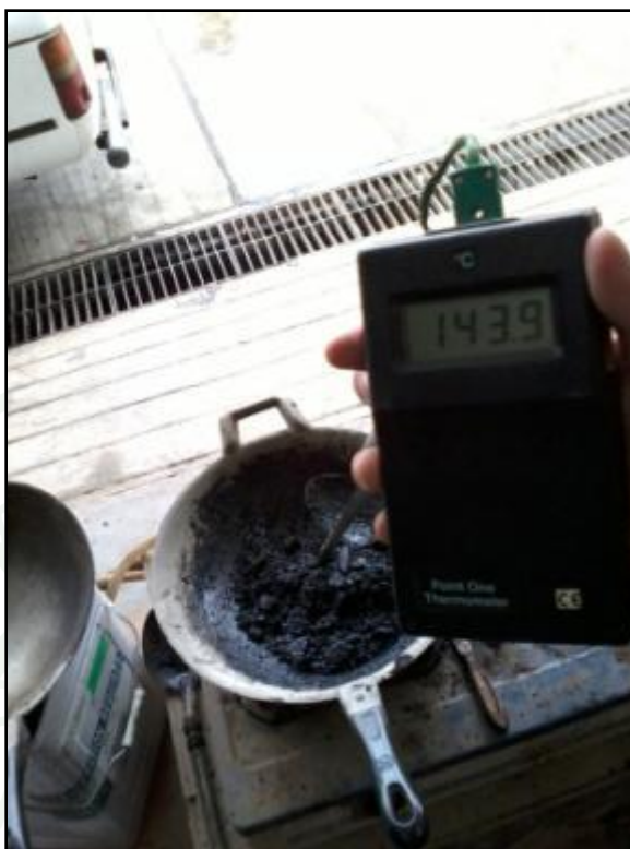
ภาพผนวกที่ ง39 การวัดอุณหภูมิแอสฟัลต์ กระบวนการผสมร้อน
