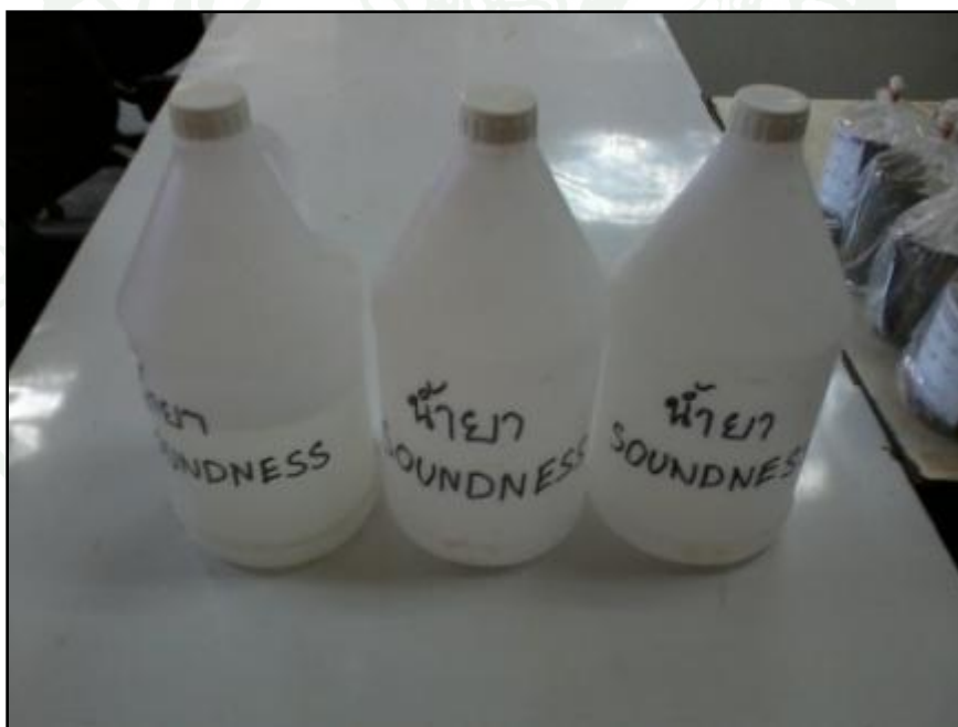
ภาพผนวกที่ ง36 สารละลายโซเดียมซัลเฟต ใช้ในการทดสอบ Soundness
