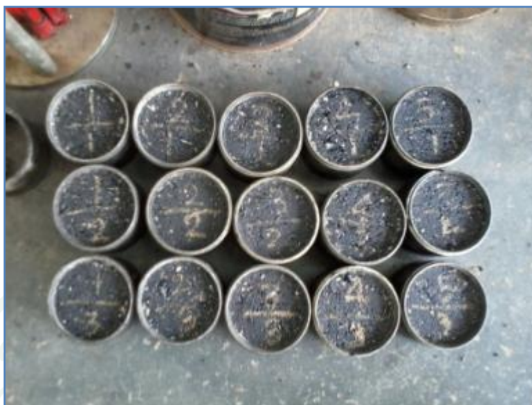
ภาพผนวกที่ ง63 ก้อนตัวอย่างพาราแอสฟัลต์คอนกรีต ด้วยกระบวนการผสมอุ่น
