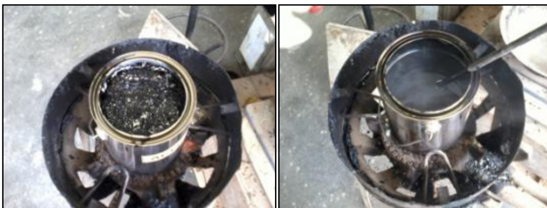
ภาพผนวกที่ ง55 ลักษณะก้อน Masterbatch ก่อนผสม และเมื่อผสมเข้ากันแล้ว
