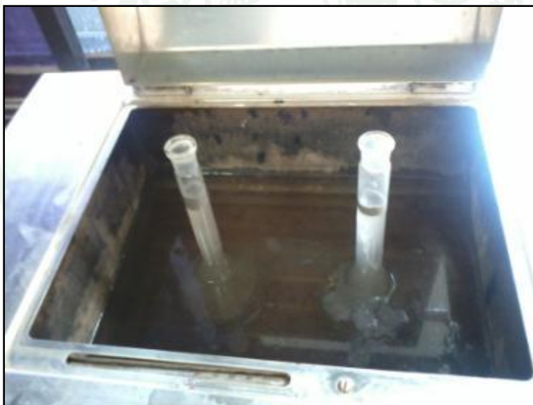
ภาพผนวกที่ ง20 การต้มหินฝุ่น เพื่อไล่ฟองอากาศ
