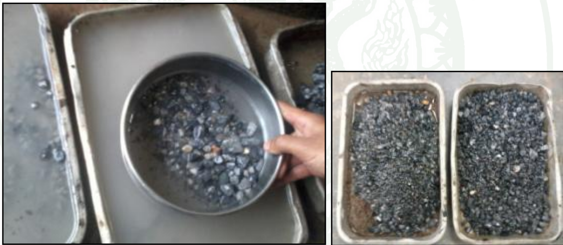
ภาพผนวกที่ ง12 การล้างหินหลังจากทดสอบ Los Angeles
