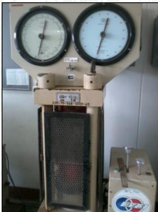
ภาพผนวกที่ ๔๘ เครื่องกดก้อนตัวอย่าง การทดสอบ Strength Index
