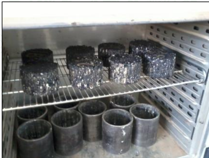
ภาพผนวกที่ ๕๐ การเข้าเครื่องอบที่ 60 °C การทดสอบ Strength Index
