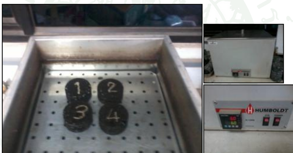
ภาพผนวกที่ ๖52 การแช่ตัวอย่างไนโซเดียมคลอไรด์ เป็นเวลา 1 ชั่วโมง การทดสอบ Strength Index
