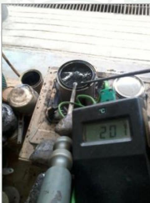
ภาพผนวกที่ ง56 อุณหภูมิที่ใช้ในการผสม ประมาณ 200 °C
