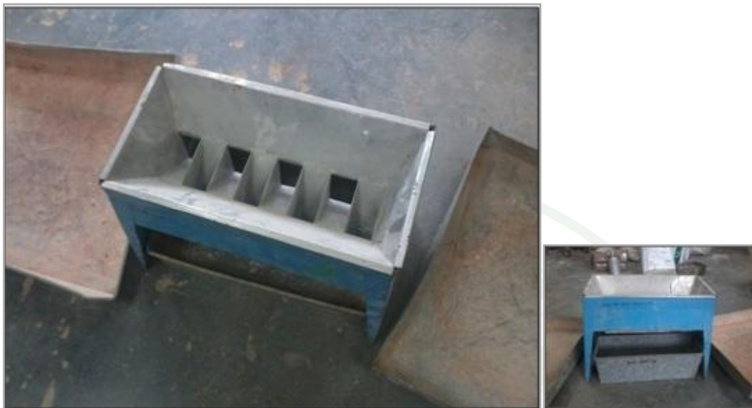
ภาพผนวกที่ ง3 เครื่องแบ่งตัวอย่าง (Sample Splitter) ขนาดต่าง ๆ
