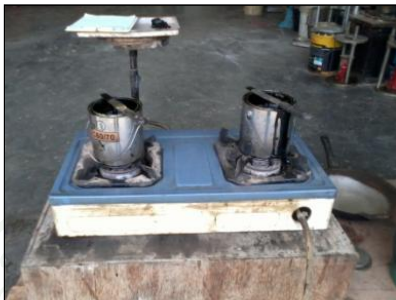
ภาพผนวกที่ ง57 การผสมตัวอย่าง Masterbatch ตามที่ออกแบบไว้
