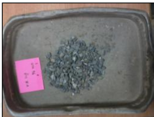
ภาพผนวกที่ ง27 วัสดุมวลละเอียด ที่จะทำการทดสอบ Soundness ๒
