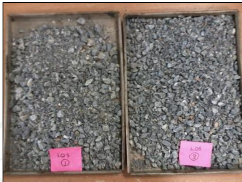
ภาพผนวกที่ ง15 หลังจากนำหินที่ล้างแล้วเข้าสู่ตูบ ของการทดสอบ Los Angeles
