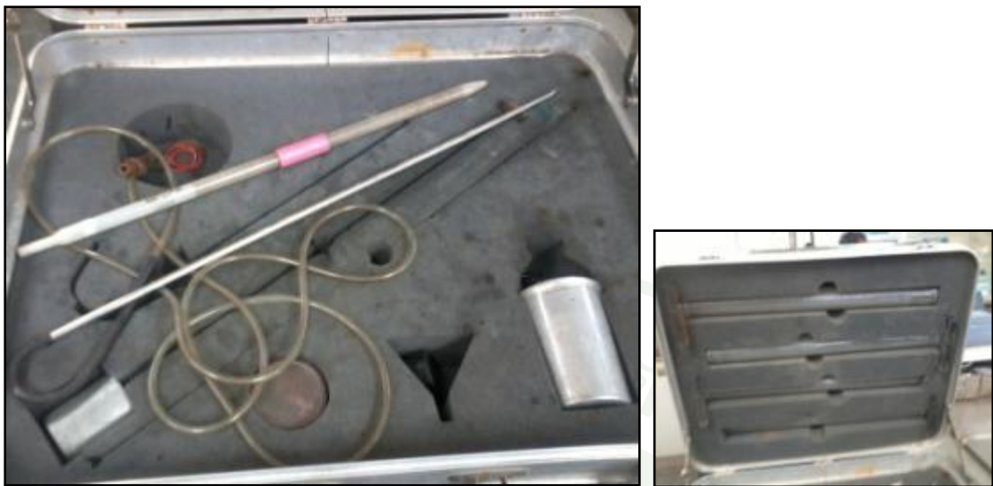
ภาพผนวกที่ ๙ อุปกรณ์ทดสอบ Sand Equivalent
