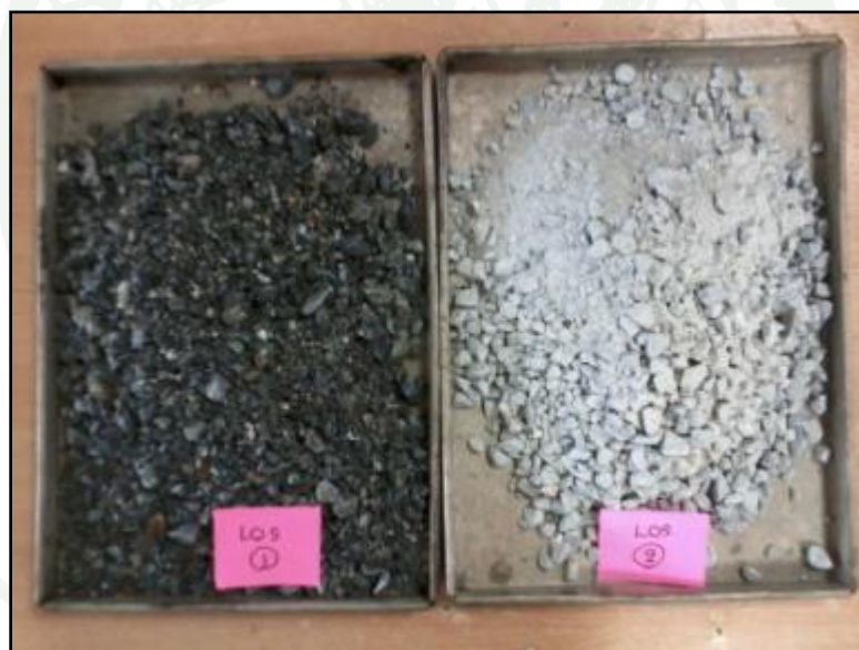
ภาพผนวกที่ ง13 หินที่ล้าง และเข้าตู้อบเรียบร้อยแล้ว ของการทดสอบ Los Angeles
