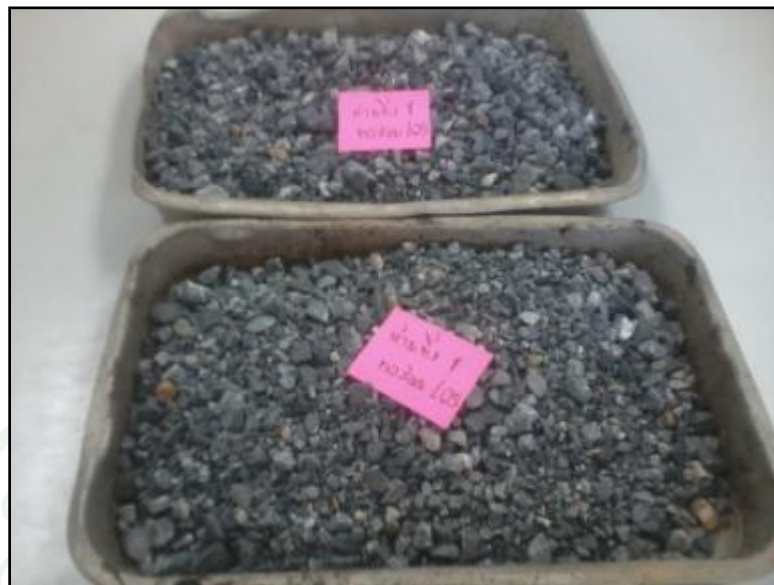
ภาพผนวกที่ ง13 หินที่ล้าง และเข้าตู้อบเรียบร้อยแล้ว ของการทดสอบ Los Angeles
