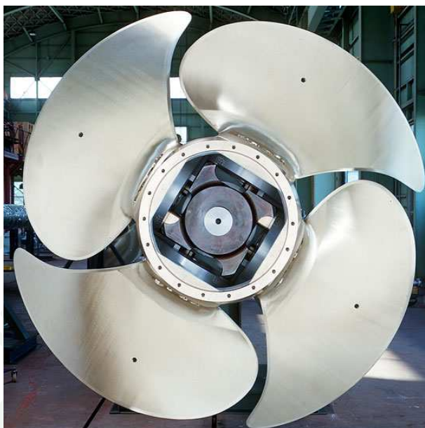
ภาพที่ 7 Controllable pitch propeller
