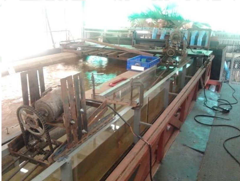
ภาพที่ 28 ฟลูมและชุดประกอบการทดลอง
