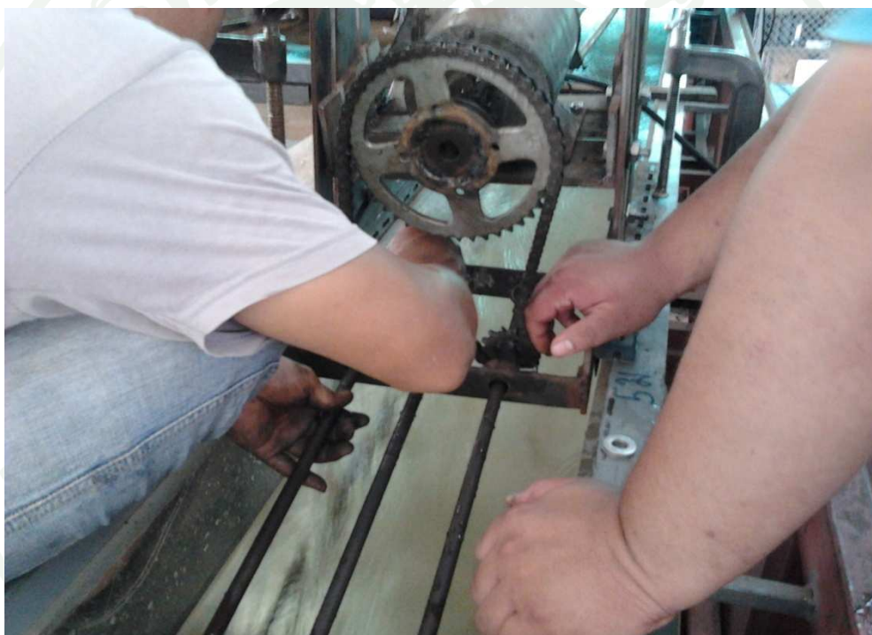
ภาพที่ 35 การติดตั้งแกนเพลาใบพัดเข้ากับชุดมอเตอร์
