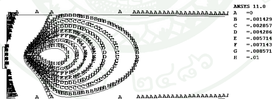
ภาพที่ 23 ระดับของหน่วยแรงภายในบริเวณเอวคาน เนื่องจากการอัดแรงเพียงแรงเดียว
