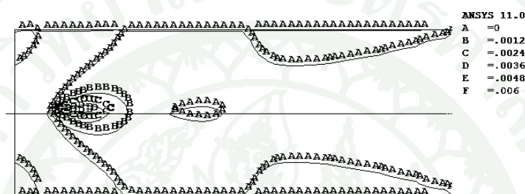
ข. บริเวณปีกคานด้านบน
