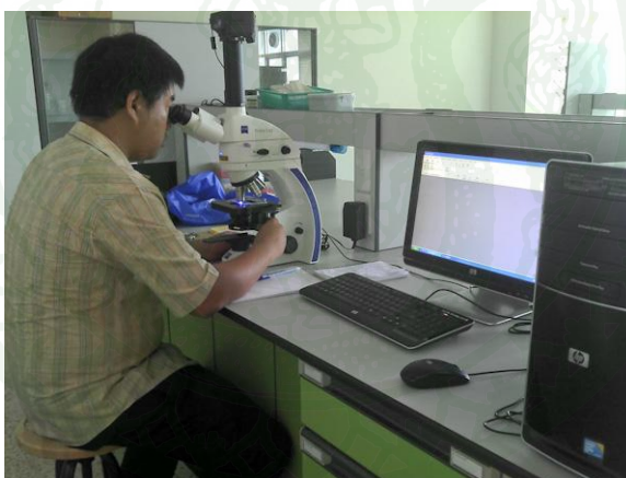
ภาพผนวกที่ 13 กล้องจุลทรรศน์ Carl Zeiss รุ่น AXIO Primo Star iLED (Carl Zeiss, Germany) ซึ่งประกอบด้วยกล้องถ่ายภาพ Canon รุ่น EOS 1000D
