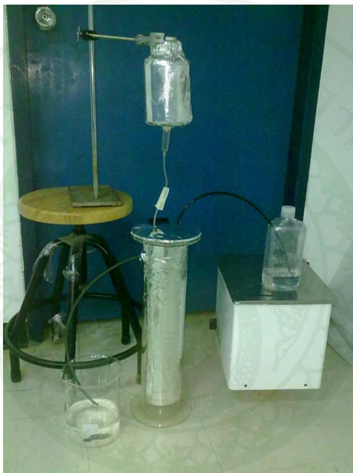
ภาพที่ 7 ชุดการทดลองการศึกษาการย่อยสลายของเสียและการผลิตก๊าซชีวภาพ
