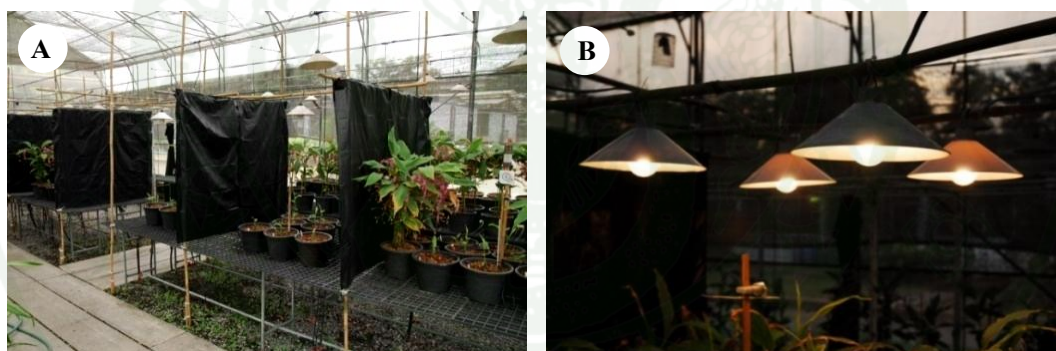
ภาพผนวกที่ 12 สภาพแวดล้อมและอุปกรณ์ในการทดลองสำหรับการทดลองที่ 1.2 (A) ฉากทึบแสงติดตั้งตามแนวทิศทางการขึ้นลงของดวงอาทิตย์ (B) หลอดไฟชนิด Incandescent lamp, INC ขนาด 100 วัตต์ ควบคุมความเข้มแสงเหนือทรงพุ่ม 50 \mu\text{mol m}^{-2} \text{s}^{-1}
