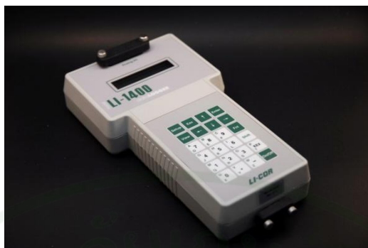
ภาพผนวกที่ 18 เครื่องวัดและบันทึกข้อมูลความเข้มแสงรุ่น LI-1400, LI-COR, USA
