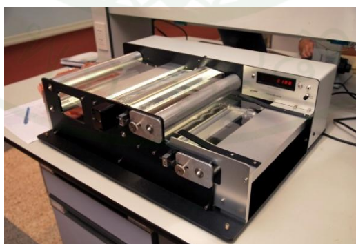
ภาพผนวกที่ 17 เครื่องวัดพื้นที่ใบ รุ่น LI-3100, LI-COR, USA
