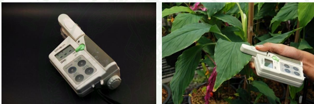
ภาพผนวกที่ 16 เครื่องวัดความเขียวของใบ MINOLTA Chlorophyll Meter รุ่น SPAD-502, JAPAN
