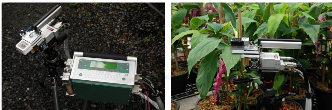
ภาพผนวกที่ 15 เครื่องวัดการแลกเปลี่ยนก๊าซและอัตราการสังเคราะห์ด้วยแสงรุ่น LI-6400 XT, LI-COR, USA
