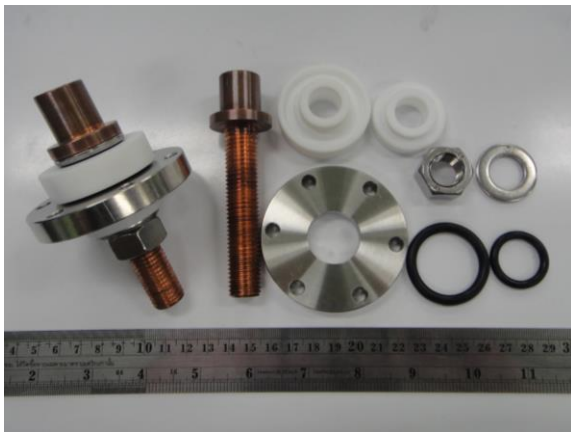
ภาพที่ 4-17 ขั้วไฟฟ้าสุญญากาศสำหรับจ่ายไฟฟ้าให้ชุดให้ความร้อนแบบลวดต้านทาน
