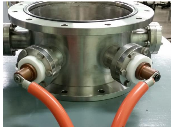
ภาพที่ 4-17 ขั้วไฟฟ้าสุญญากาศสำหรับจ่ายไฟฟ้าให้ชุดให้ความร้อนแบบลวดต้านทาน
