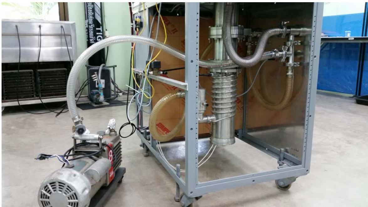
ภาพที่ 4-9 ลักษณะการติดตั้งเครื่องสูบแบบแพร่ไอน้ำมันและเครื่องสูบลอโรตารีของเครื่องเคลือบ
